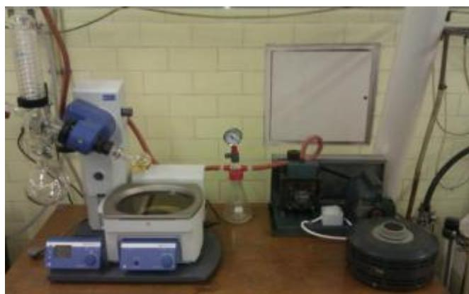
**Slika 3.1.** Rotacijski vakuum isparivač *IKA RV 10, Basic*
