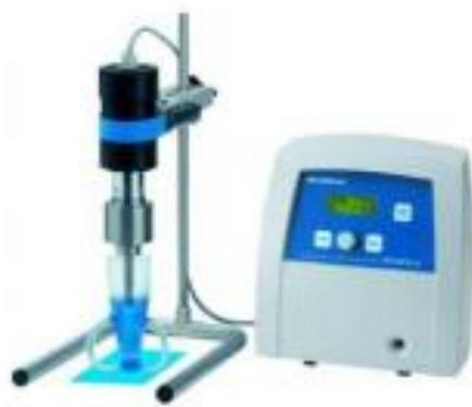
**Slika 3.2.** Ultrazvučni homogenizator *Bandelin sonoplus HD 3200*
