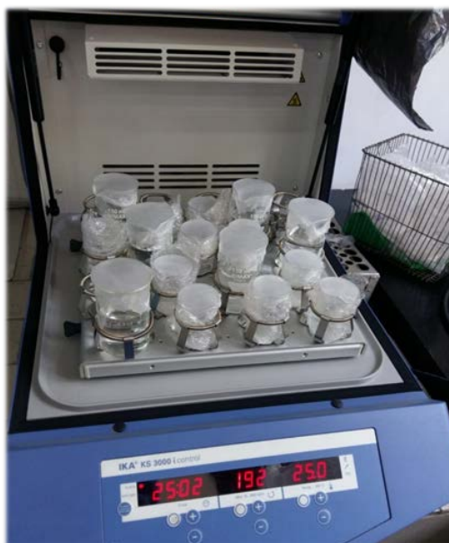
Slika 20. Fotografija laboratorijske tresilice IKA KS 3000 (IKA ® -Werke GmbH & Co. KG, Staufen, SR Njemačka).
