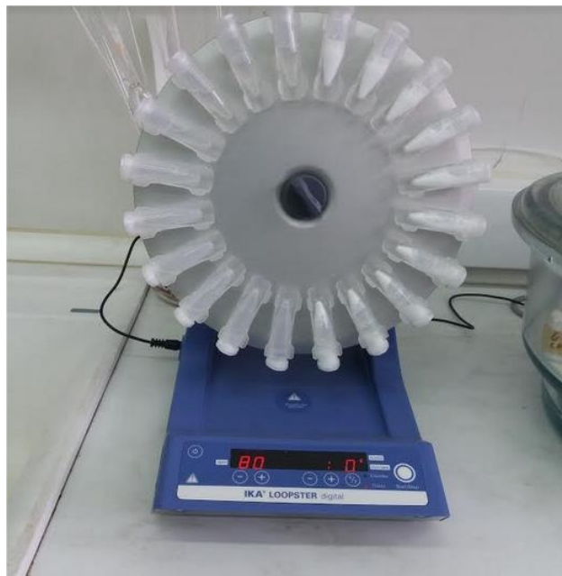
Slika 7. Aparatura za provođenje kinetičkih i adsorpcijskih mjerenja. Konstruirano prema referenci [52].
