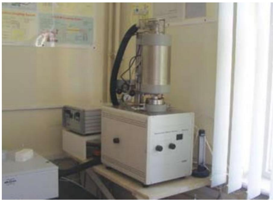
Slika 5. Termogravimetrijski analizator (TGA) NetzschSTA409 [29].
