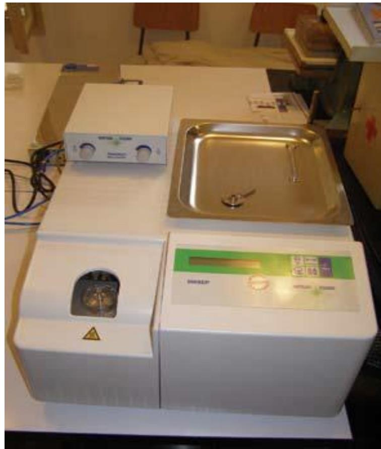
**Slika 6.** Diferencijalni pretražni kalorimetar (DSC) Mettler Toledo DSC823<sup>e</sup> [29].
