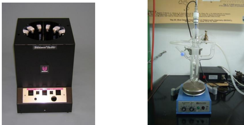
Slika 4.1. a) Fotokemijski reaktor Rayonet RPR 100; b) Reaktor s unutarnjim osvjetljavanjem
