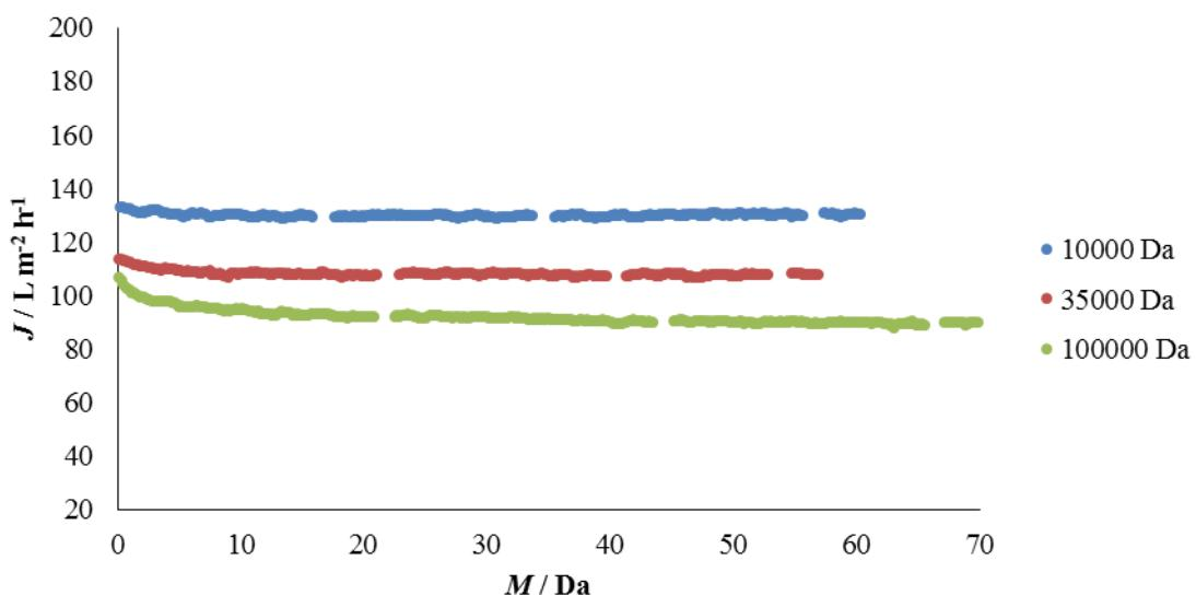
Slika 4.10. Ovisnost protoka permeata o vremenu, prilikom propuštanja otopina različitih molekulske masi kroz PW membranu.
