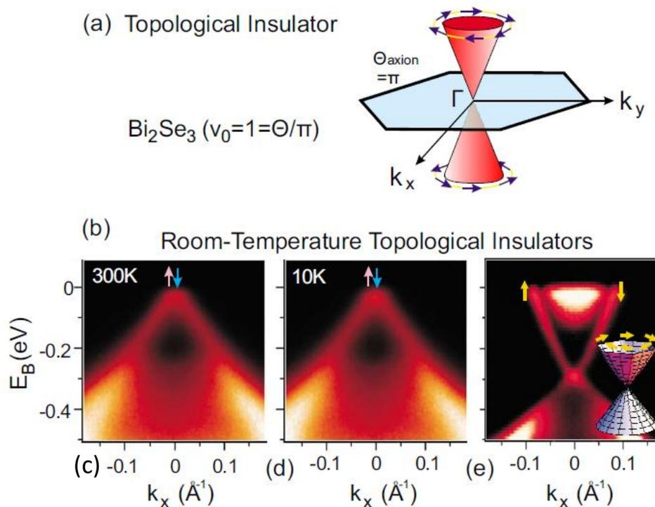
Slika 34. (b) Topološki izolator pri sobnoj temperaturi, rezultati dobiveni tehnikom ARPES; (c) pokazuje zadržavanje svojstava pri  $T=300\text{K}$  i Diracov konus pri sobnoj temperaturi. (d) Diracov stožac pri 10 K. (e) Potpuni Diracov stožac.<sup>[4]</sup>
