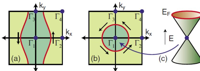
Slika 29. Prikaz 4 invarijantne točke ( $\Gamma_{1,2,3,4}$ ) i Fermijevih krugova na površini Brillouinove zone za (a) slabi topološki izolator, (b) jaki topološki izolator. (c) U najjednostavnijem jakom topološkom izolatoru Fermijev krug tvori jednu Diracovu točku.
