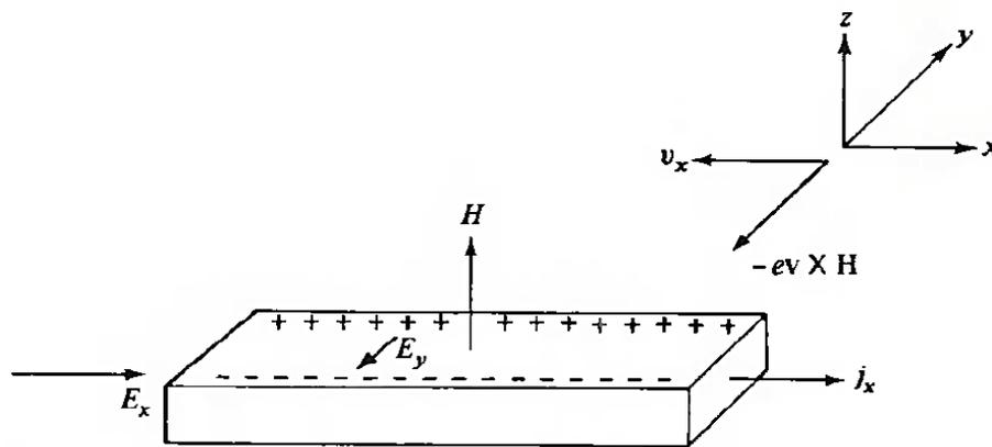
Slika 2. Shematski prikaz Hallovog eksperimenta. <sup>[12]</sup>
