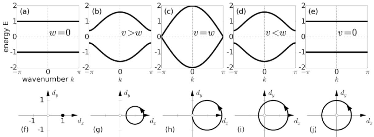
Slika 16. Različiti slučajevi preskakujućih amplituda za SSH model sa pripadajućim vektorom  $d(k)$
