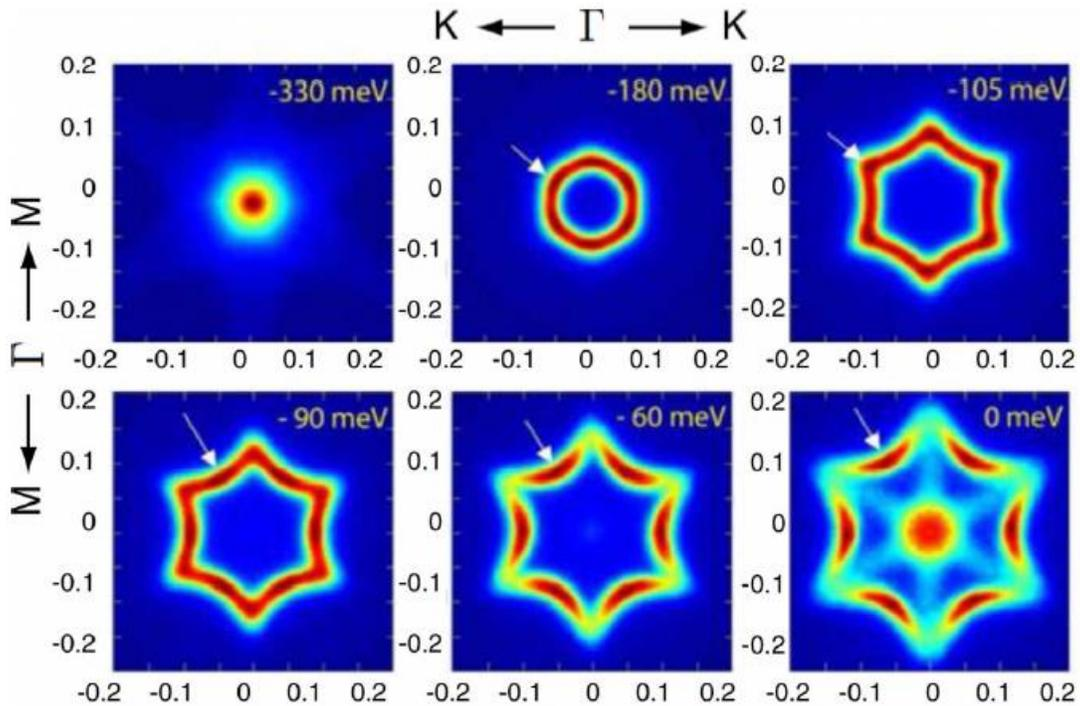
Slika 35. Heksagonalna deformacija površinskih stanja  $\text{Bi}_2\text{Se}_3$  dobivena tehnikom ARPES. [4]
