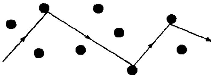
Slika 1. Putanja vodljivog elektrona u jednostavnom Drudeovom modelu. Elektroni se sudaraju sa nepokretnim ionima rešetke. <sup>[12]</sup>
