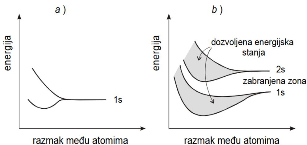
Slika 5. Cijepanje energetskih nivoa: a) 2 atoma istog energijskog stanja ; b) nastajanje vrpca <sup>[6]</sup>
