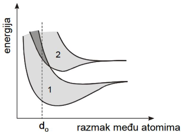
Slika 7. Elektronska struktura metala: preklapanje valentne vrpce popunjene elektronima (1) i prazne vodljive vrpce (2) na razmaku među atomima  $d_0$ .<sup>[6]</sup>
