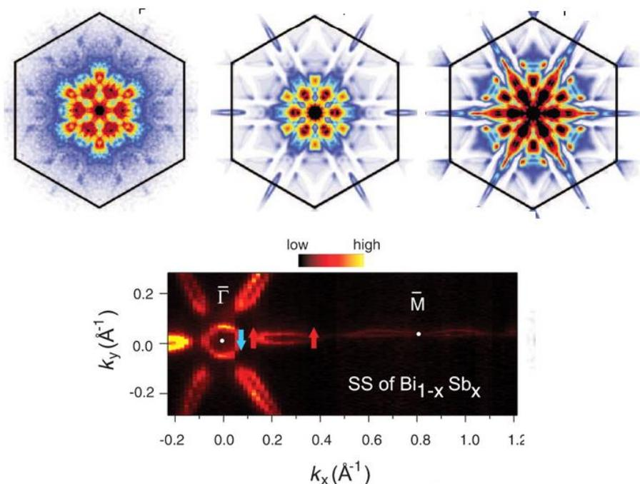
Slika 32. Prikaz struktura površinskih stanja mjerenih pri Fermijevoj energiji dobivenih tehnikom ARPES spektroskopije. <sup>[4]</sup>
