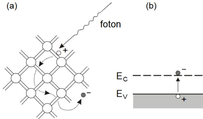
Slika 11. Skica nastajanja nosilaca naboja i vodljivosti u intrinzičnom poluvodiču: a) foton visoke energije  $h\nu > E_g$  predaje energiju elektronu u kovalentnoj vezi, b) oslobođeni elektron u vodljivoj vrpci i pozitivna šupljina u valentnoj vrpci. [6]
