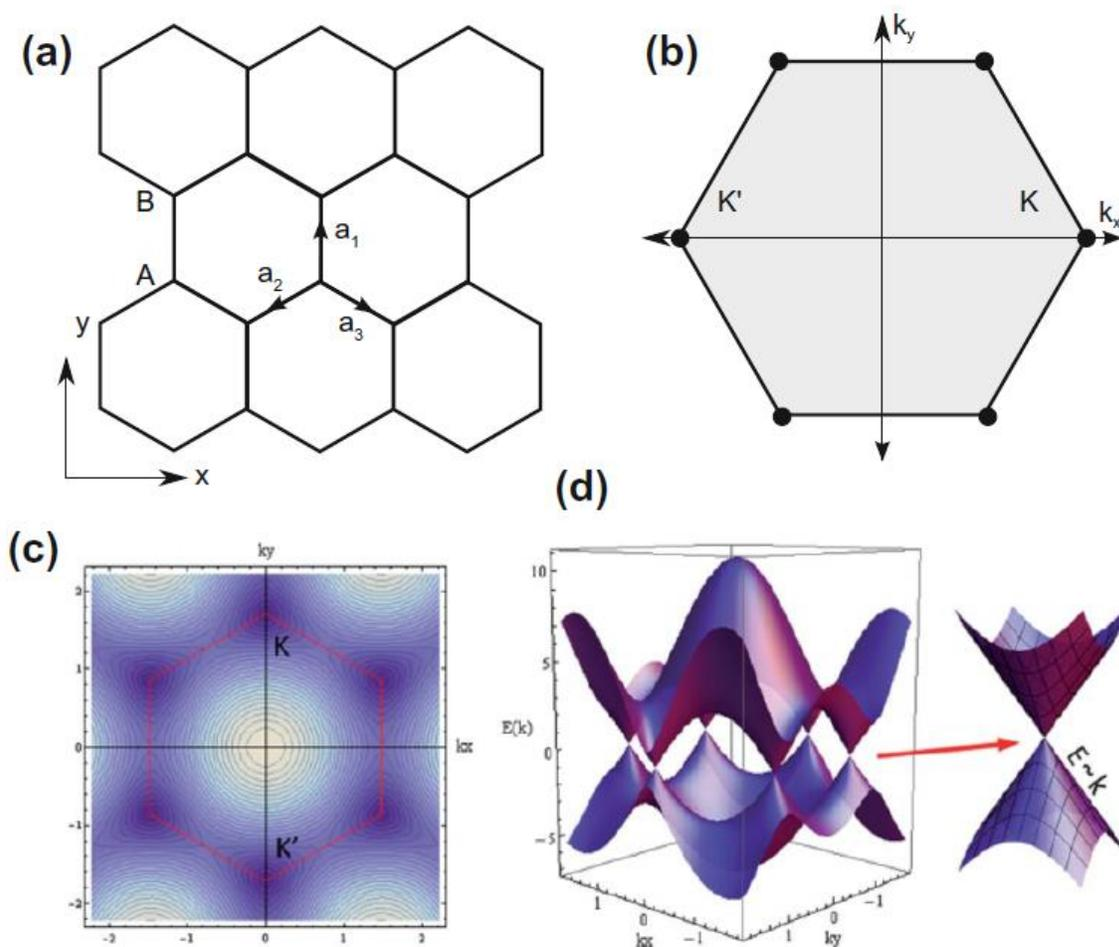
Slika 20. (a) Kristalna rešetka grafena. (b),(c) Brillouinova zona u grafenu sa prikazom rubnih točaka K i K' , (d) Dvije vrpce  $p_z$  orbitale, koje se dodiruju u dvije točke u ćeliji (K i K') te uvećan prikaz Diracove točke. <sup>[1][5]</sup>
