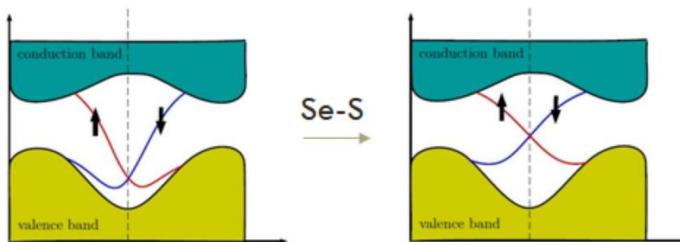
Slika 39. Shematski prikaz pomicanja Diracove točke zamjenom selenija sumporom.<sup>[5]</sup>
