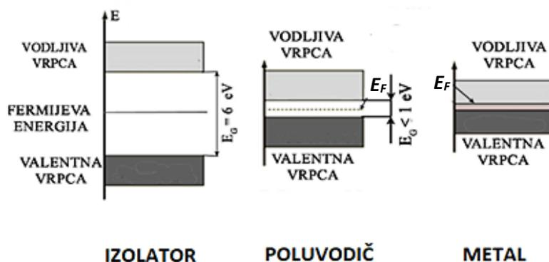
Slika 10. Prikaz strukture elektronskih vrpca i Fermijevih energija za različite materijale.<sup>[7]</sup>
