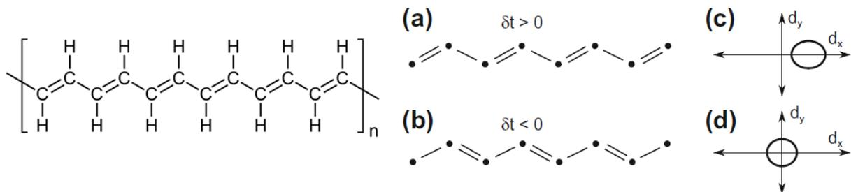
Slika 13. Prikaz strukture i dva različita dimerizirana stanja poliacetilena u SSH modelu (a), (b); (c),(d) Prikaz jediničnog vektora  $\hat{d}(k)$ . <sup>[1]</sup>
