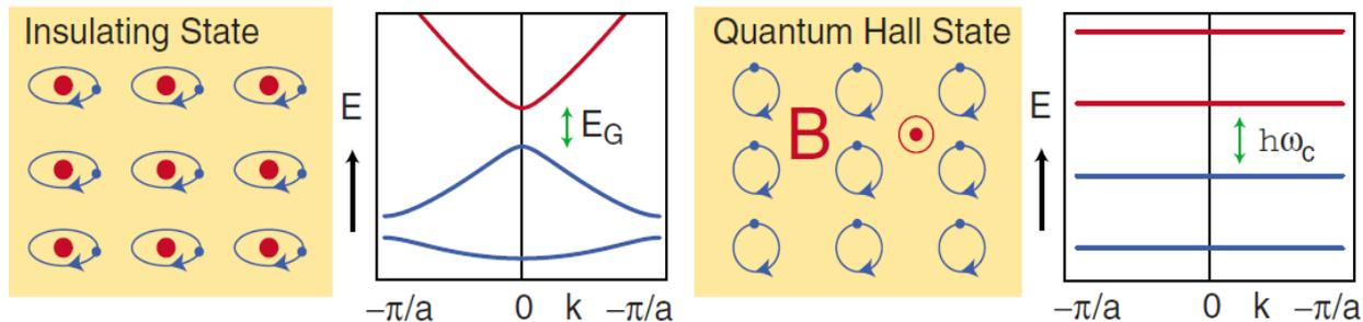
Slika 18. Prikaz: (a) izolatorskog stanja i pripadajućih energetske razina, (b) Stanja kvantnog Hall efekta nakon primijenjenog magnetskog polja B te pripadajućih Landau razina. <sup>[4]</sup>
