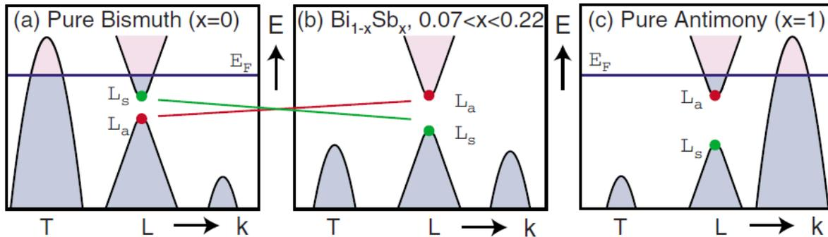
Slika 31. Shematski prikaz vrpca u  $\text{Bi}_{1-x}\text{Sb}_x$ , koji prelazi iz (a) polumetalnog ponašanja za  $x < 0.07$ , u (b) poluvodičko za  $0.07 < x < 0.22$  pa ponovo u (c) polumetalno za  $x > 0.22$ . [4]
