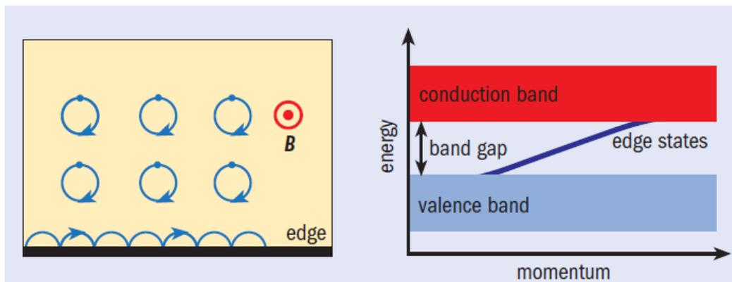
Slika 21. Prikaz kvantnog Hall efekta – ciklotronsko kretanje elektrona u magnetnom polju ( $B$ ) je prekinuto granicom gdje elektroni preskakuju orbitale što vodi do nastanka vodljivog kanala u jednom smjeru duž ruba. <sup>[13]</sup>
