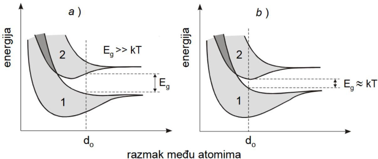
Slika 8. Nastajanje elektronskih vrpca: Izolator (a) i poluvodič (b); 1 - popunjena elektronima valentna i 2 - prazna vodljiva vrpca. <sup>[6]</sup>
