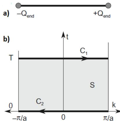
Slika 16. a) Polarizacija u 1D je određena  $Q_{end}$ . b) Promjena u polarizaciji je opisana promjenom Berrijeve faze na petljama  $C_1$  i  $C_2$ . <sup>[1]</sup>
