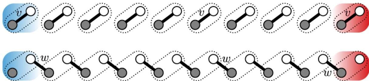
Slika 16. Potpuno dimerizirana rubna stanja SSH modela poliacetilena nastala raspadom lanca na nepovezane dimere. <sup>[10]</sup>
