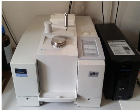
Slika 14. FTIR-ATR spektrofotometar Spectrum One, Perkin Elmer
