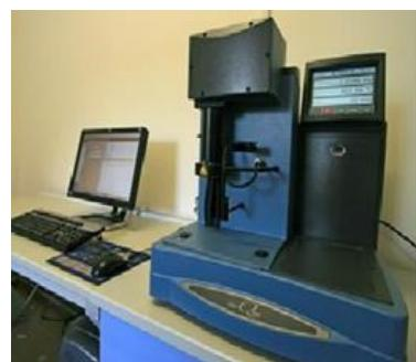
*Slika 13. Termogravimetar, Q500 TA Instruments*
