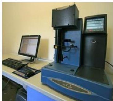
Slika 13. Termogravimetar, Q500 TA Instruments
