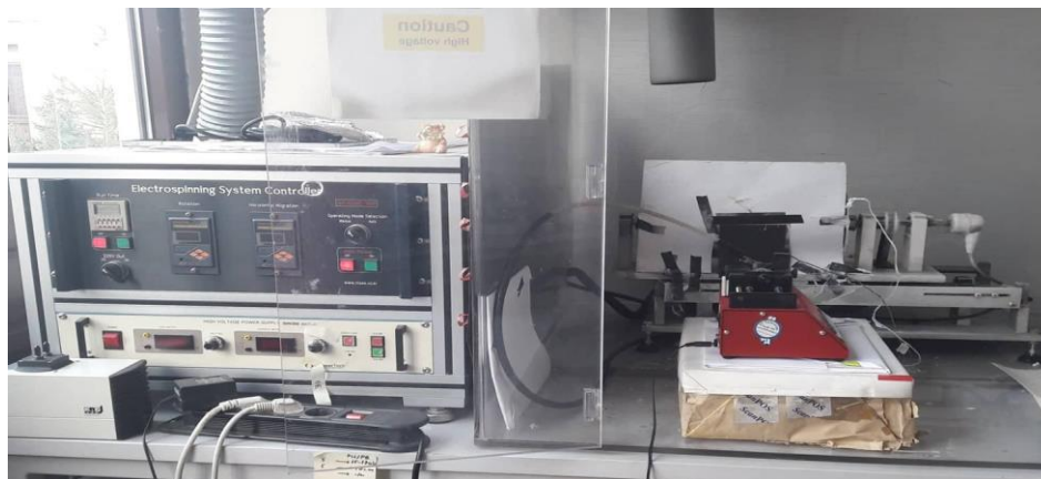
Slika 10. Uređaj za elektroispredanje NT-ESS-300, NTSEE Co. Ltd. South Korea
