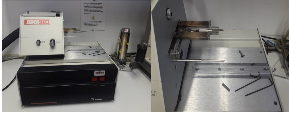
Slika 12. Dinamičko mehanički analizator DMA 983
