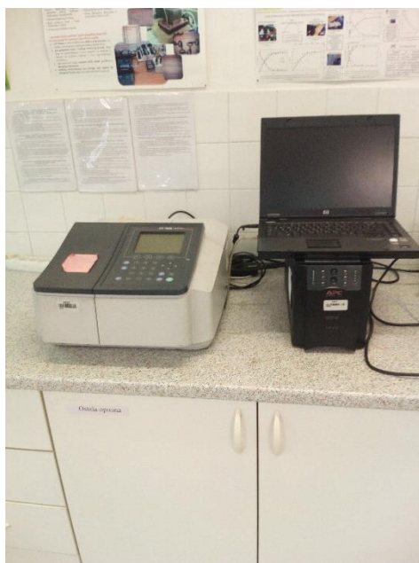
Slika 3.2.3.1. UV/Vis spektrofotometar Shimadzu UV-1800
