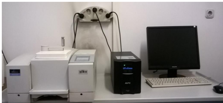
Slika 30. FTIR spektrofotometar, FTIR Spectrum One, Perkin Elmer povezan s računalom
