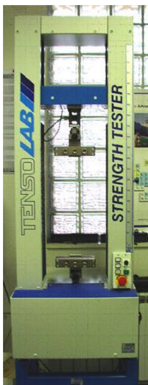
Slika 28. Univerzalna kidalica, TensoLab 3000, tt. Mesdan
