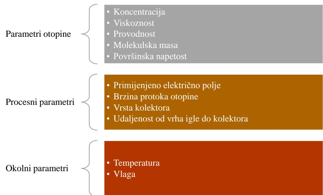
**Slika 21.** Karakteristični parametri kod postupka elektroispredanja
