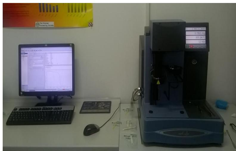
*Slika 31. Termogravimetar, Q500 TA Instruments*
