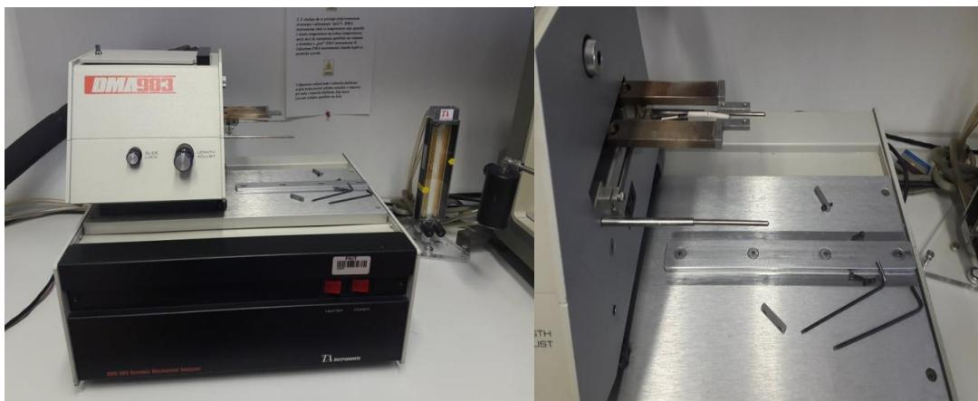
Slika 27. Dinamičko mehanički analizator, DMA 983, TA Instruments
