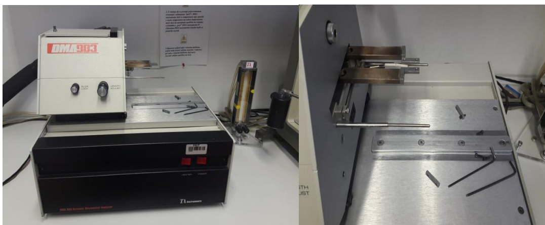
Slika 27. Dinamičko mehanički analizator, DMA 983, TA Instruments
