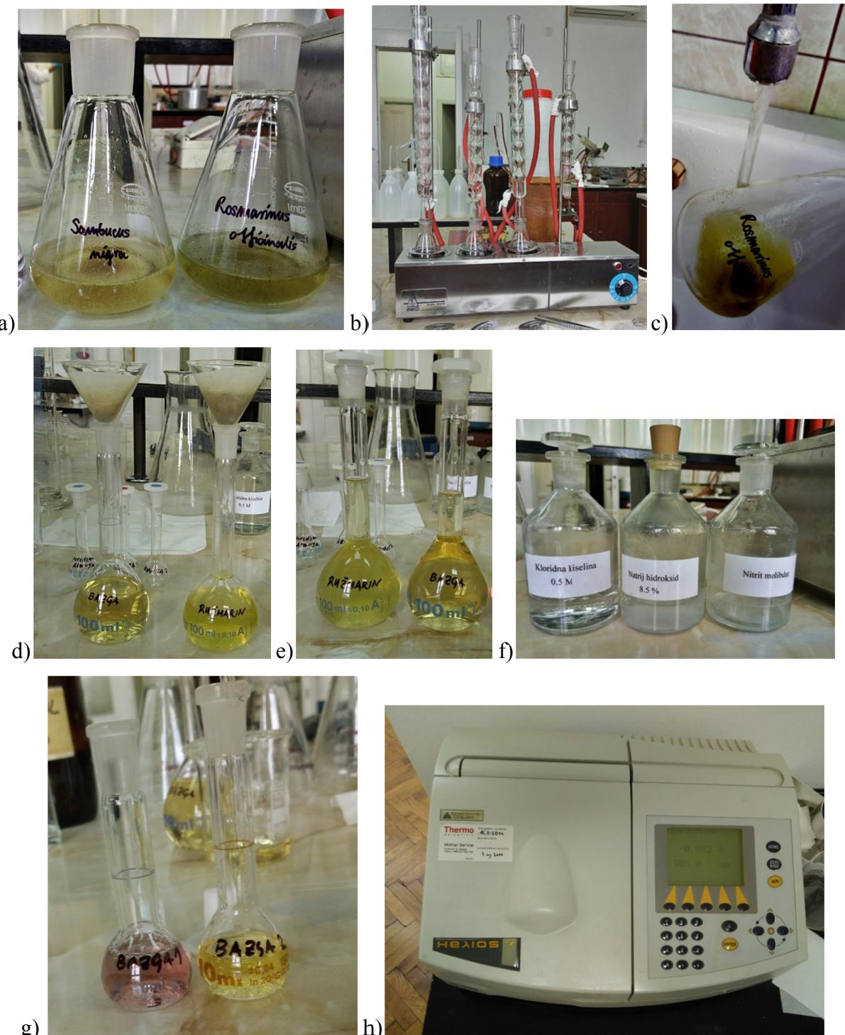
**Slika 12.** Određivanje fenolnih kiselina; (a) priprema uzorka za ekstrakciju; (b) ekstrakcija na vodenoj kupelji uz povratno hladilo; (c) hladjenje tikvice pod mlazom hladne vode; (d) filtriranje alkoholnog ekstrakta; (e) dopunjavanje 50 %-tnim etanolom do oznake; (f) reagensi; (g) priprema poredbena i ispitivane otopine; (h) mjerjenje apsorbancije otopina
