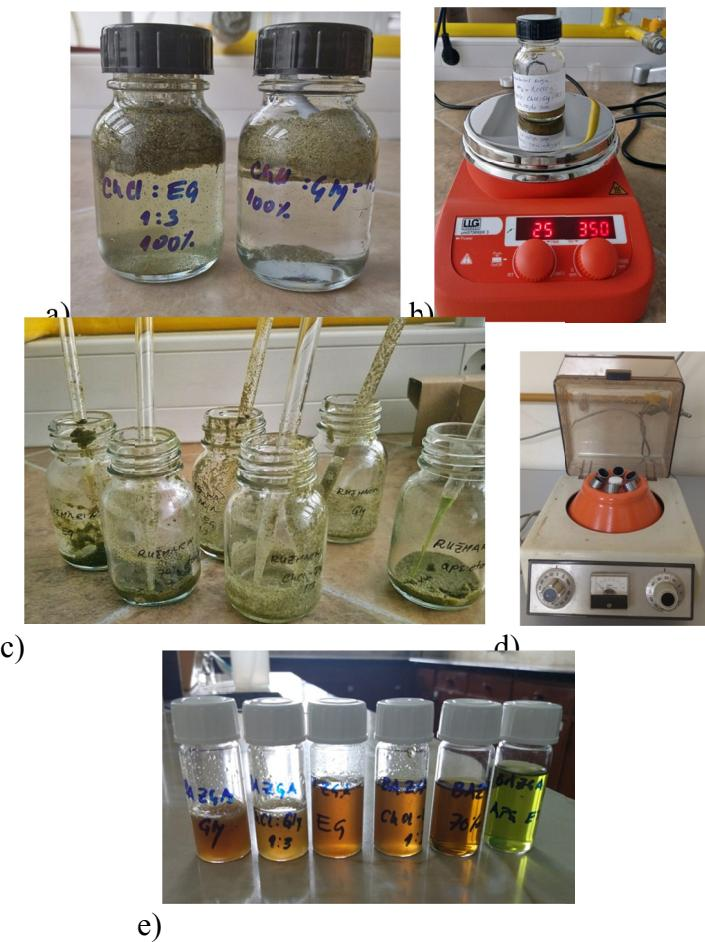
**Slika 17.** Pripremanje ekstrakta; a) 4 g suhe biljne tvari pomiješano s 40 mL otapala; b) miješanje na magnetskoj miješalici; c) staklene boćice sa zaostalim talogom; d) laboratorijska centrifuga za odijeljivanje; e) pripremljeni ekstrakti spremni za analizu
