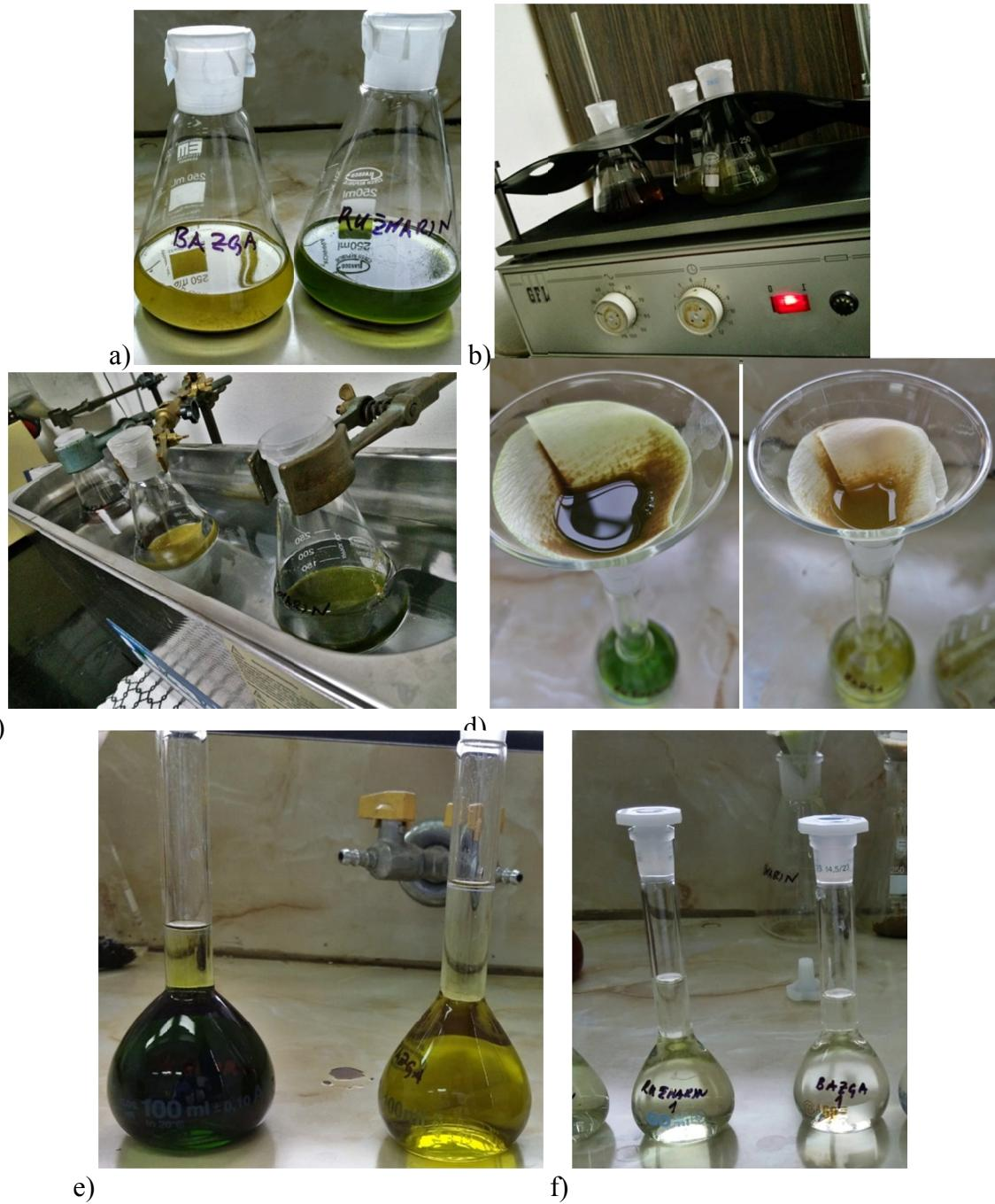
**Slika 15.** Određivanje antocijana; a) usitnjeni biljni materijal pomiješan s metanolom; b) ekstrakcija mućkanjem na laboratorijskoj tresilici; c) ekstrakcija u ultrazvučnoj kupelji; d) filtriranje ekstrakta ružmarina i bazge; e) nadopunjavanje ekstrakta do oznake metanolom; f) ispitivane otopine spremne za analizu
