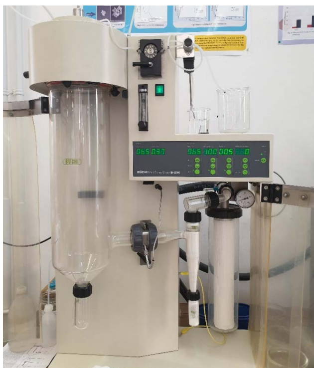
Slika 9. Sušionik s raspršivanjem Mini Spray Dryer B-290
