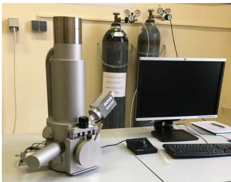
Slika 11. Tescan Vega 3 SEM i naparivač (sputter coater) Quorum SC7620
