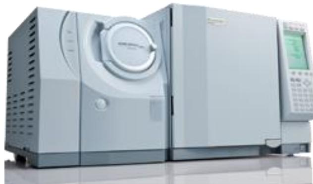
Slika 14. Plinski kromatograf QP 2010 plus sa spektrometrom masa
