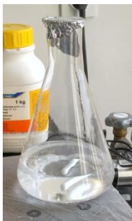
Slika 3.11. Tikvica s otopinom n – butanola i KOH na magnetskom miješalu
