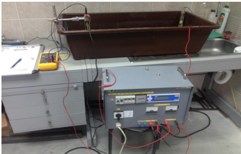
Slika 3-3. Sustav katodne zaštite pomoću napojne stanice
