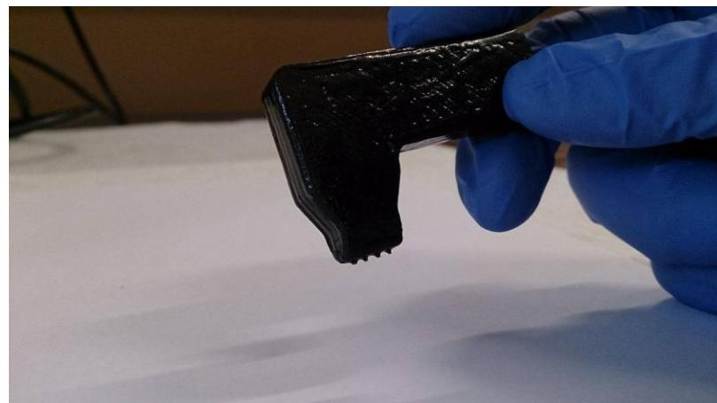
*Slika 3.10.* Sonda s četiri vrha za mjerenje električne provodnosti.
