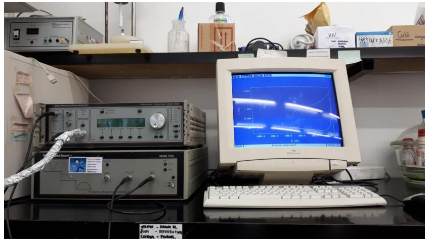
*Slika 3.9. Aparatura za elektrokemijska ispitivanja; potencijostat EG&G Princeton Applied Research, model 263 A*
