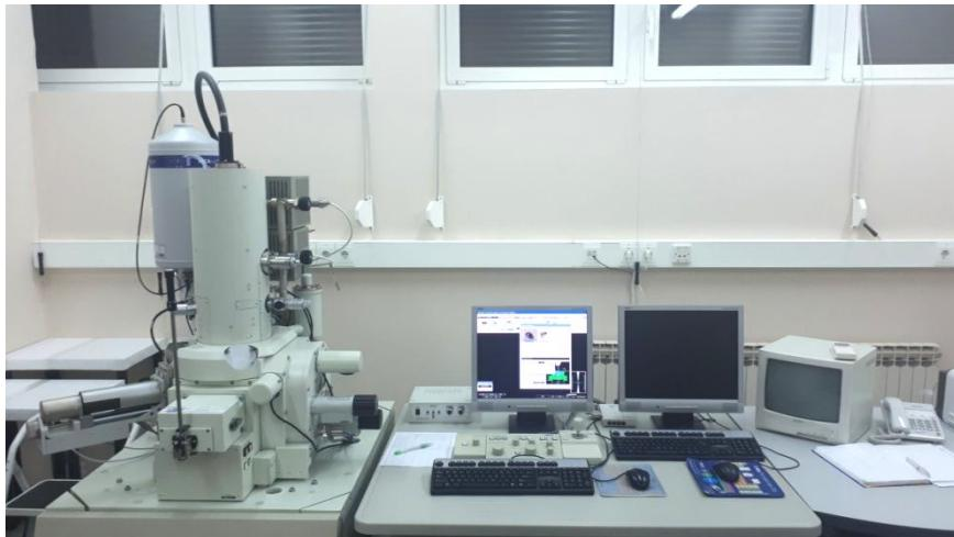
Slika 3.4. Pretražni elektronski mikroskop JSM-7000F proizvođača JEOL® Ltd.
