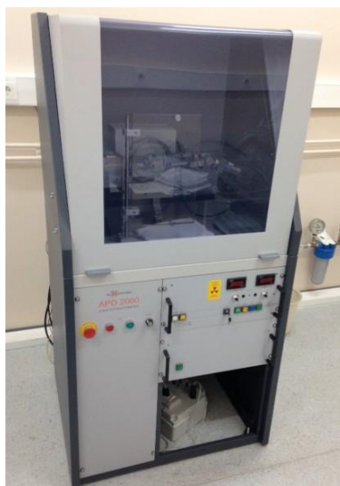
Slika 3.6. Difraktometar APD 2000 proizvođača Ital Structures®.
