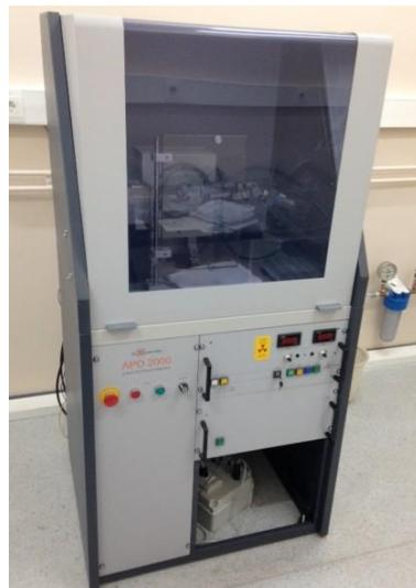
Slika 3.6. Difraktometar APD 2000 proizvođača Ital Structures®.
