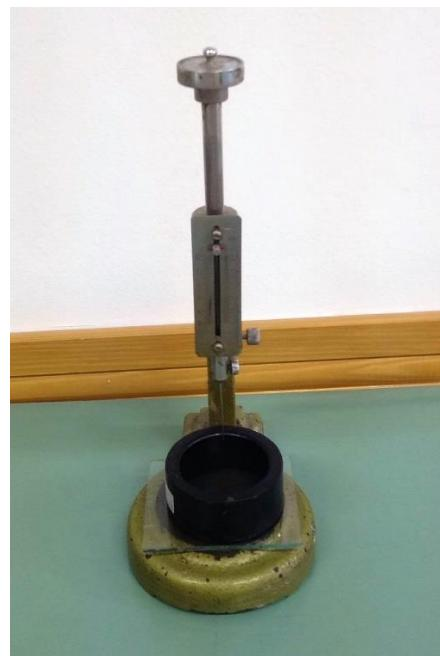
**Slika 17:** Vicat- ov aparat za određivanje vremena vezanja
