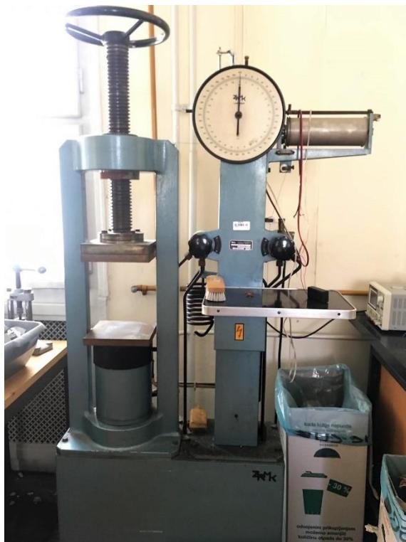
Slika 18: Hidraulička preša
