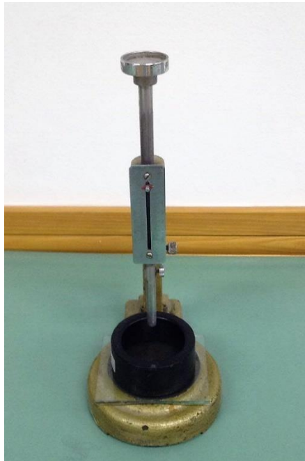
Slika 15: Vicat- ov aparat za određivanje standardne konzistencije
