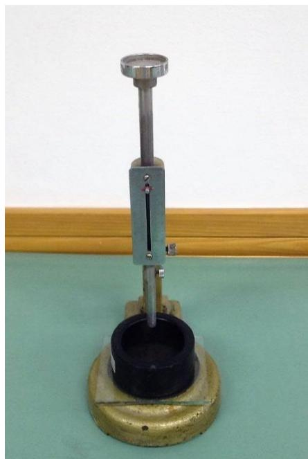
**Slika 15:** Vicat- ov aparat za određivanje standardne konzistencije
