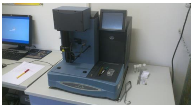
Slika 12. TGA analizator Q500, TA Instruments
