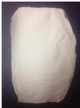
**Slika 10.** Fotografija vlaknastog mata dobivenog elektropredenjem
