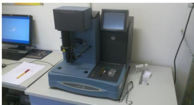
**Slika 12.** TGA analizator Q500, TA Instruments
