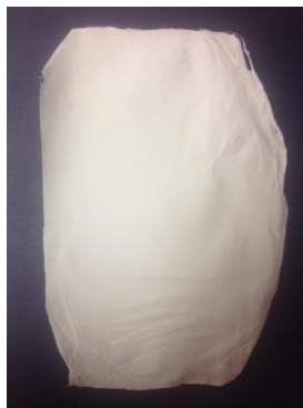
Slika 10. Fotografija vlaknastog mata dobivenog elektropredenjem
