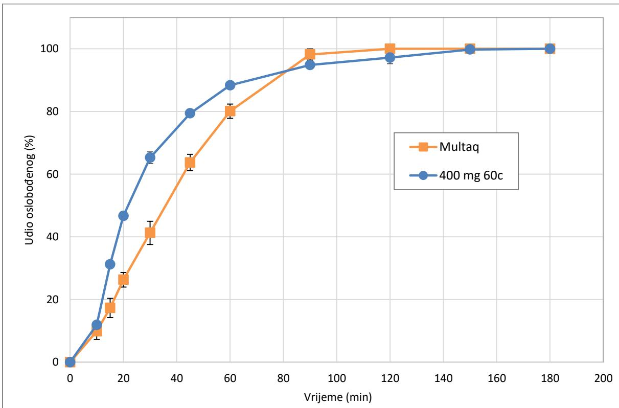
Slika 44. Usporedba profila oslobođenja DNR-a iz 400 mg 60c peleta i Multaq tablete
