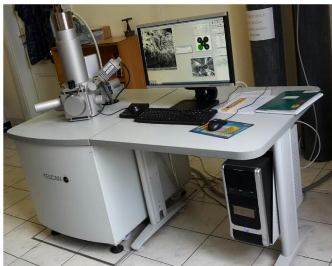
Slika 13. Pretražni elektronski mikroskop Vega 3 (*Tescan, Češka*)
