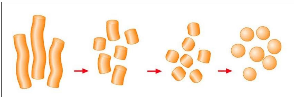
**Slika 3.** Mehanizam nastajanja peleta iz ekstrudata procesom sferonizacije
