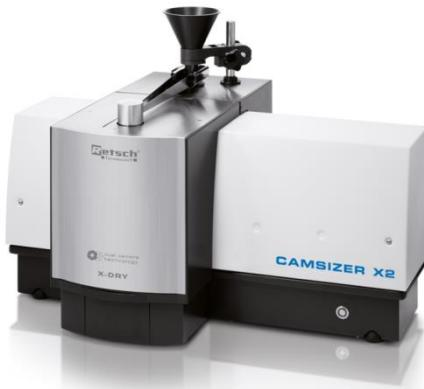
**Slika 14.** Uređaj za mjerjenje raspodjele veličina čestica (CAMSIZER X2, *Retsch Technology GmbH*)
