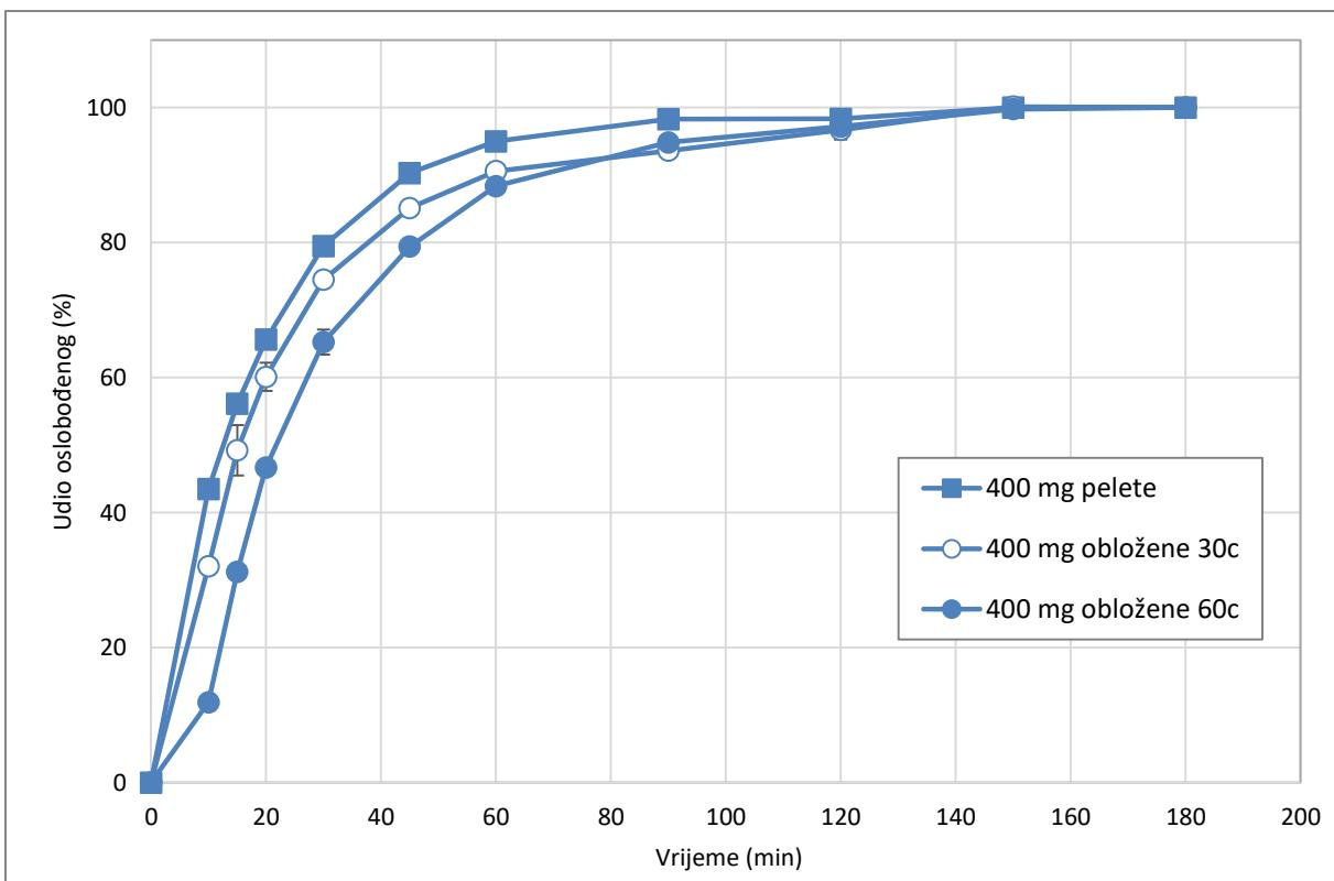
Slika 43. Usporedba profila oslobođenja DNR-a iz 400 mg peleta
