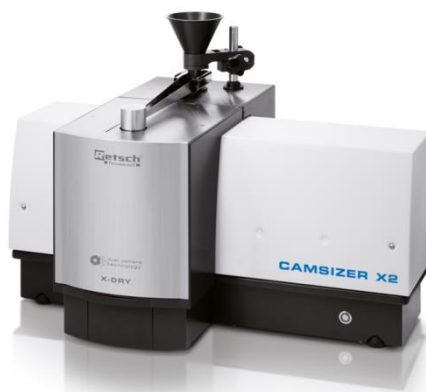
Slika 14. Uređaj za mjerenje raspodjele veličina čestica (CAMSIZER X2, Retsch Technology GmbH )
