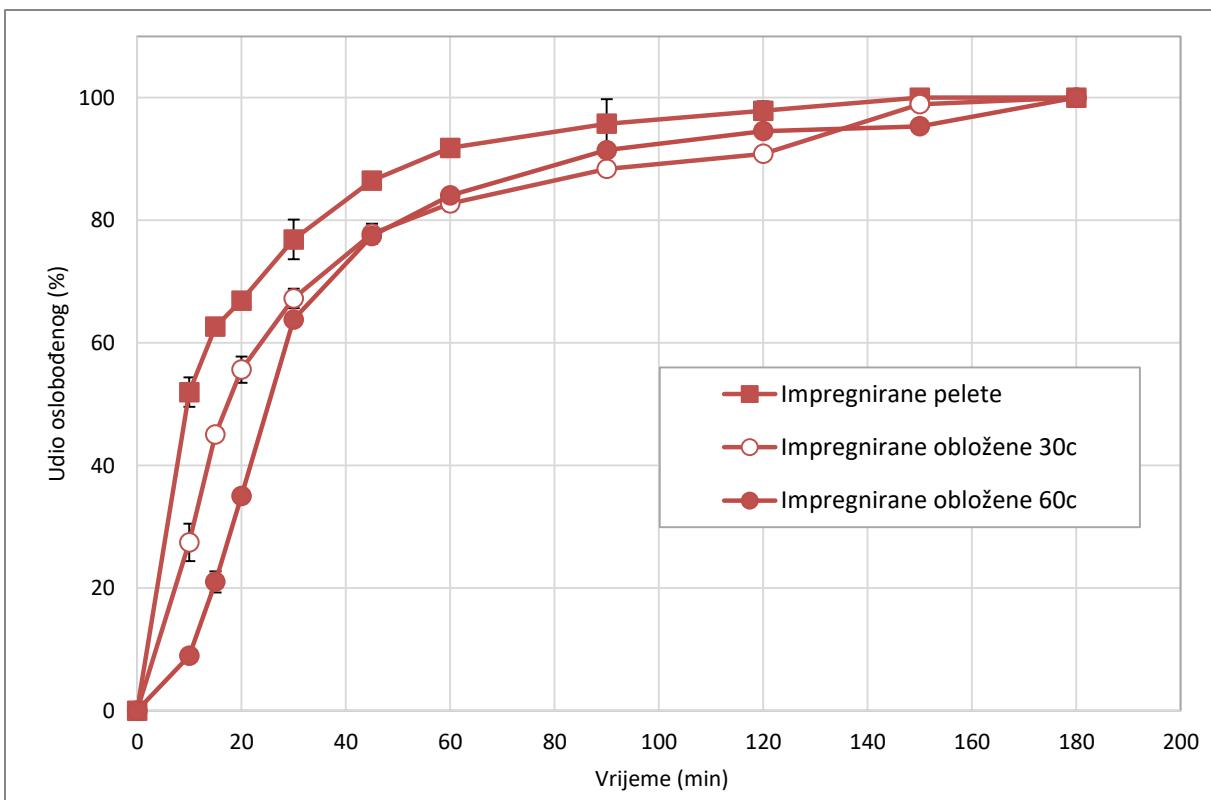
Slika 41. Usporedba profila oslobođenja DNR-a iz impregniranih peleta
