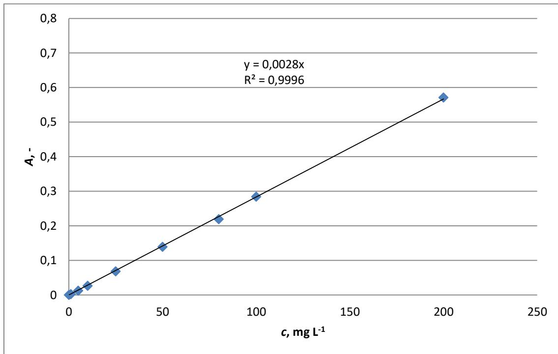
**Slika 20.** Umjerni pravac dronedaron-hidroklorida u fosfatnom puferu ( $\text{pH} = 4,5$ )
