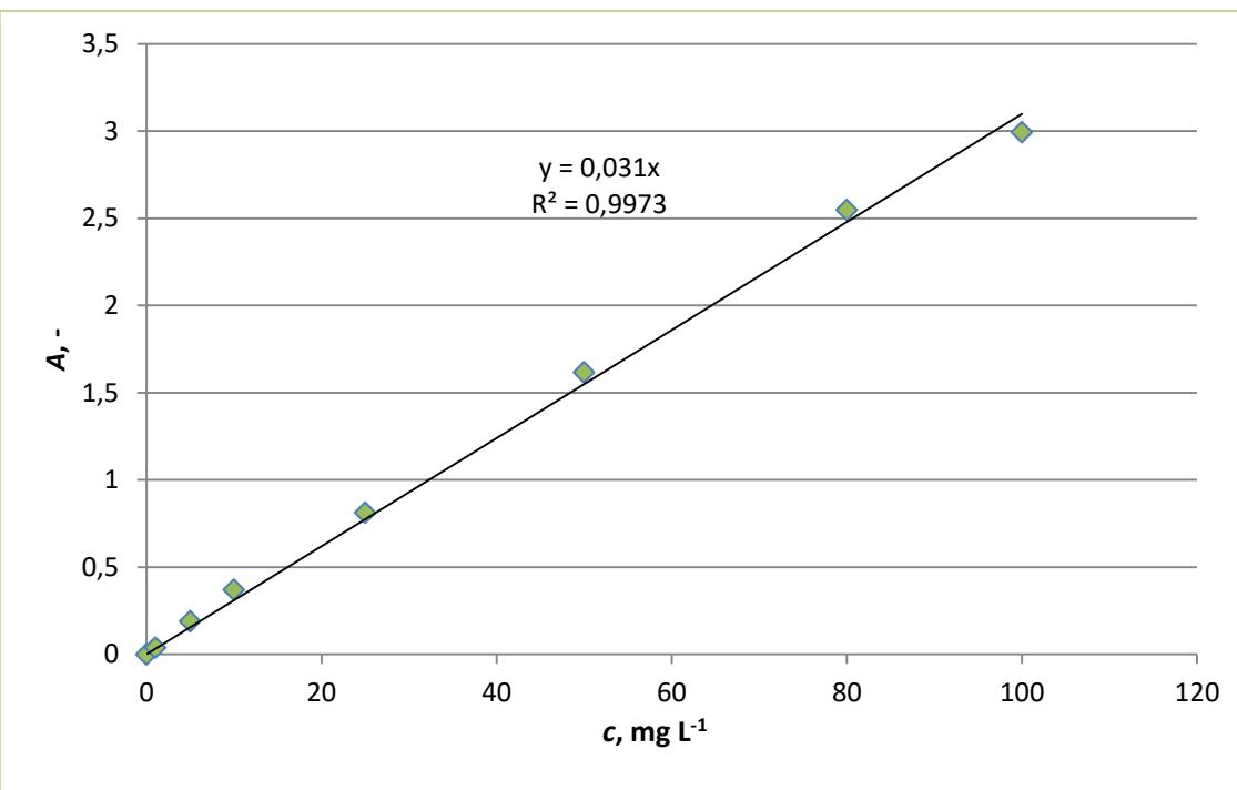
**Slika 19.** Umjerni pravac dronedaron-hidroklorida u metanol
