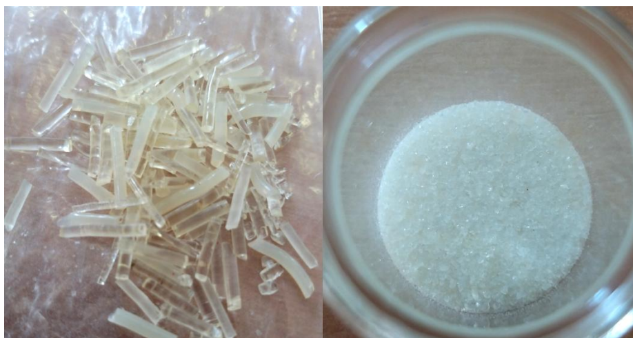
Slika 17. Uzorak CLX-SOL dobiven ekstrudiranjem pri 120 °C (CLX-SOL-120)
