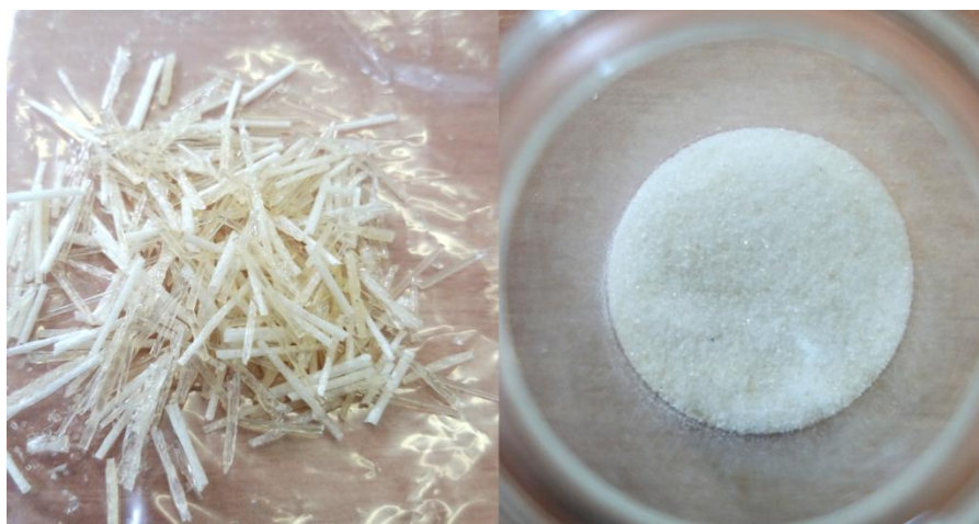
Slika 16. Uzorak CLX-SOL dobiven ekstrudiranjem pri 170 °C (CLX-SOL-170)
