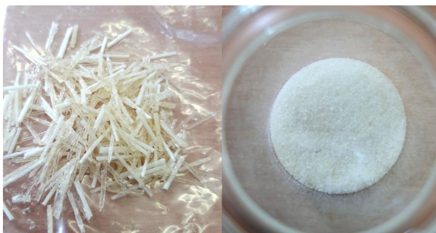
Slika 16. Uzorak CLX-SOL dobiven ekstrudiranjem pri 170 °C (CLX-SOL-170)
