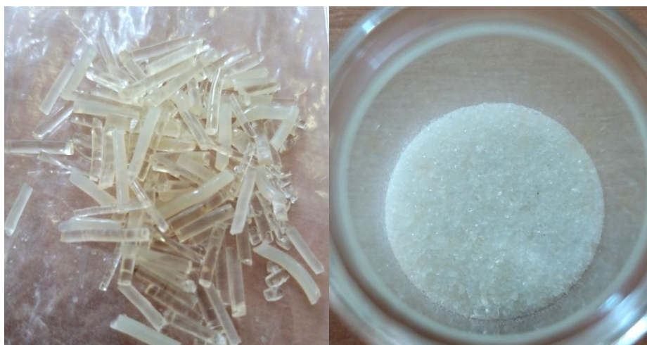
Slika 17. Uzorak CLX-SOL dobiven ekstrudiranjem pri 120 °C (CLX-SOL-120)
