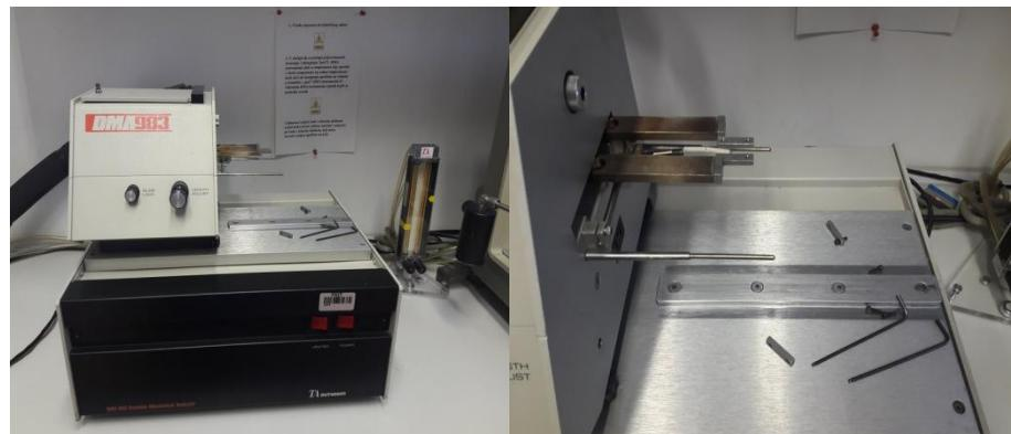
**Slika 16.** Dinamičko mehanički analizator DMA 983
