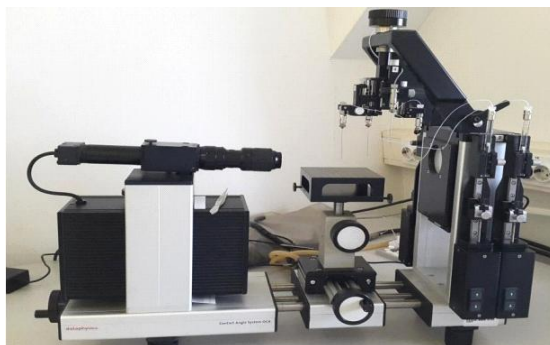
Slika 17. Goniometar, DataPhysics OCA 20 Instrument
