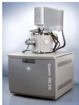
**Slika 18.** SEM mikroskop QUANTA 250, FEI
