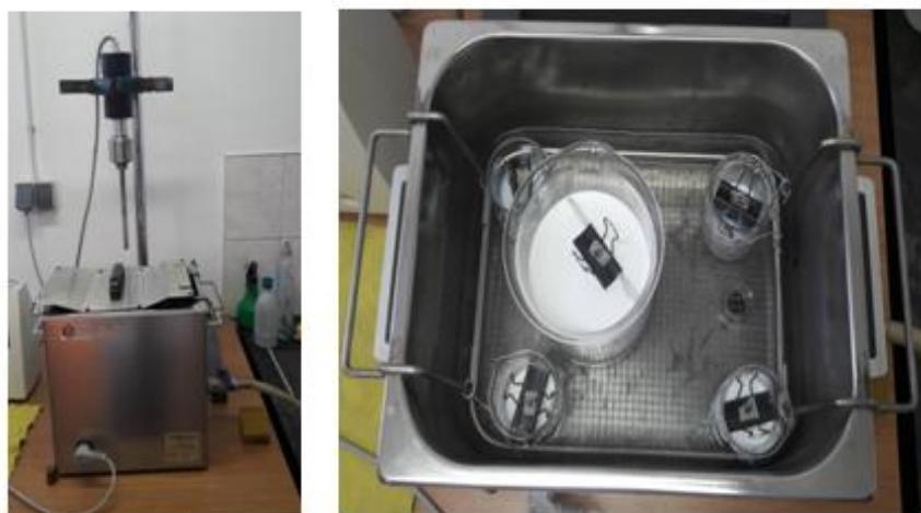
**Slika 14.** Uzorci postavljeni u ultrazvučnu kupelj
