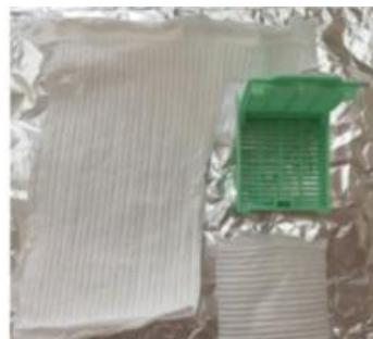
**Slika 13.** Okvir u koji se postavlja elektroispredeni vlaknasti nosači
