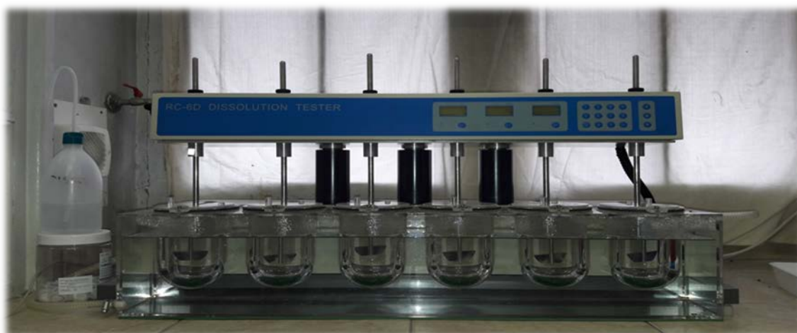
Slika 26. Fotografija uređaja za ispitivanje otpuštanja djelatne tvari RC-6D (Zhengzhou Nanbei Instrument, Henan, NR Kina)
