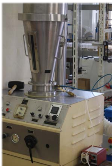
Slika 17. Fotografija granulatora s fluidiziranim slojem Uni-Glatt (Glatt GmbH, Binzen, SR Njemačka)
