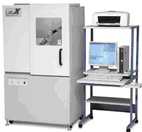
Slika 19. Fotografija uređaja za rendgensku difrakciju praha XRD-6300 (Shimadzu, Kyoto, Japan)
