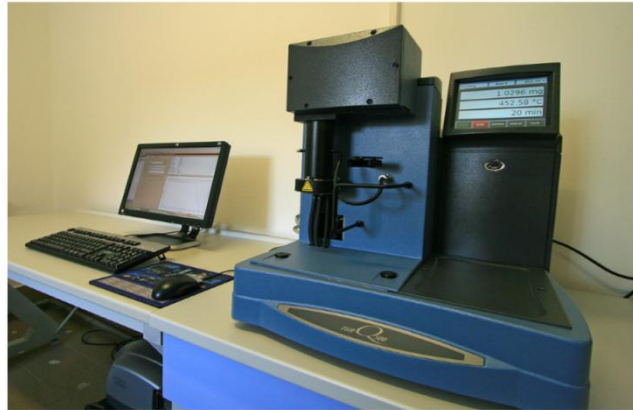
3.5.a) Shematski prikaz termovage; b) Termogravimetrijski analizator
