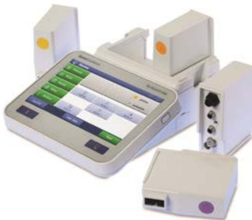
**Slika 15.** pH-metar Seven Excellence S400-osnovni (Mettler Toledo, Greifensee, Švicarska)
