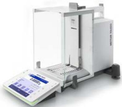
**Slika 14.** Analitička vaga Balance XPE205 (Mettler Toledo International Inc., SAD)
