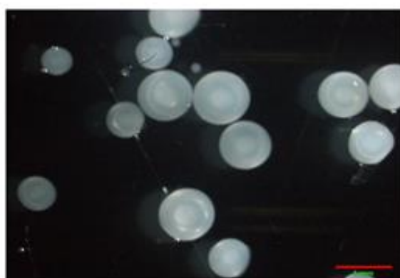
Slika 19. Raspodjela veličina i mikrografije (mikro)sfera kompleksa MC75 i metalnih iona proizvedenih pri 20 kV.
