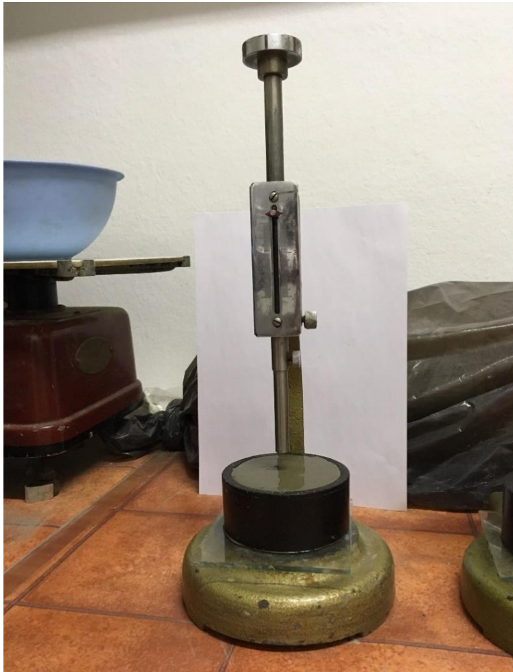
Slika 11: Aparat po Vicat-u za određivanje standardne konzistencije
