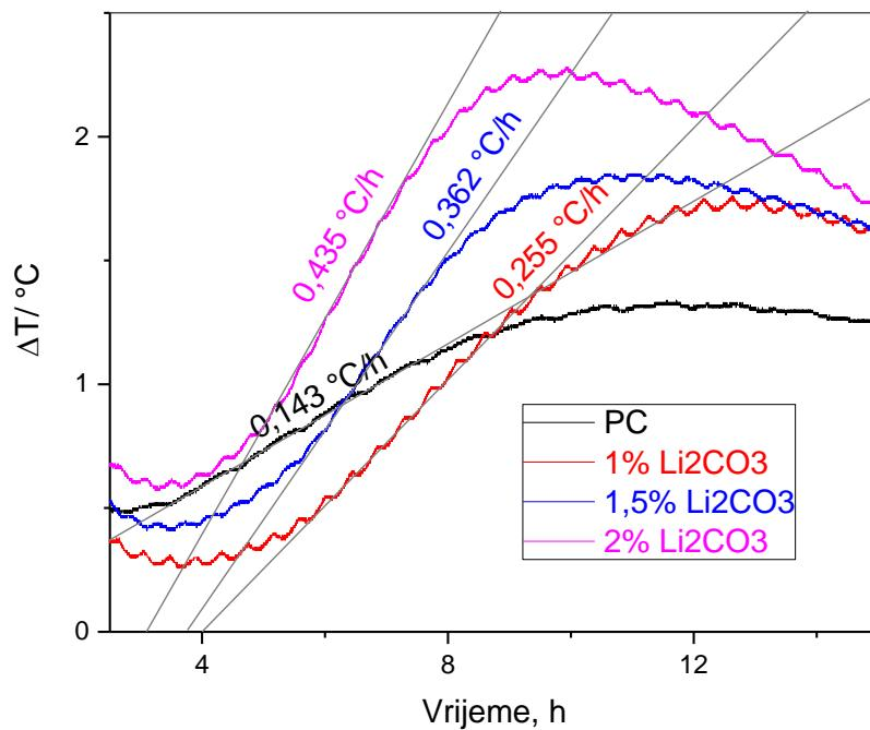
Slika 24: Detalj određivanja najveće brzine porasta temperature ispitivanih uzoraka
