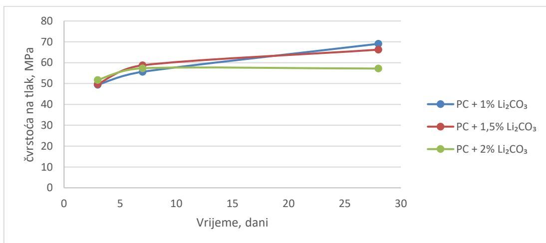
Slika 16: Čvrstoće na tlak (maseni udjeli  $\text{Li}_2\text{CO}_3$  1, 1,5 i 2 %)
