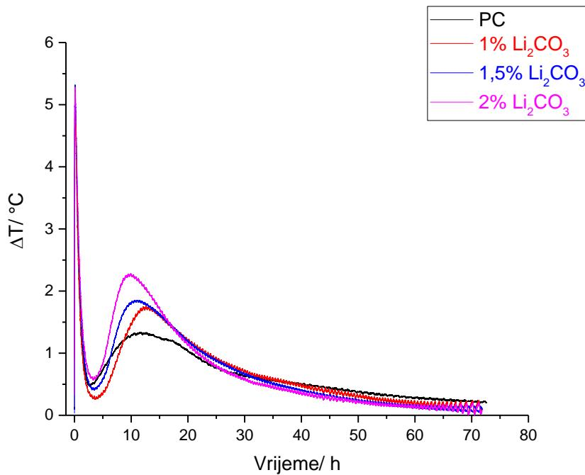
Slika 21: Promjena temperature uzorka u ovisnosti o vremenu hidratacije (72 h)
