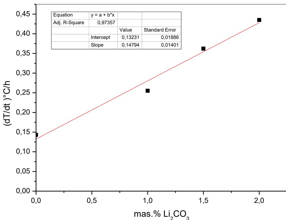
Slika 25: Promjena najveće brzine porasta temperature uzorka u ovisnosti o dodatku litijeva karbonata
