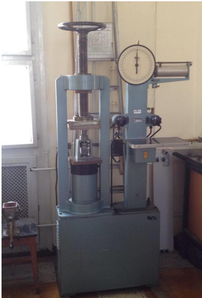
Slika 14: Hidraulična preša za određivanje čvrstoće na tlak
