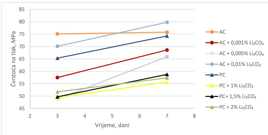
Slika 20: Usporedba čvrstoća na tlak čistog Aluminatnog i Portland cementa, te Aluminatnog i Portland cementa s dodatkom različitih masenih udjela  $\text{Li}_2\text{CO}_3$
