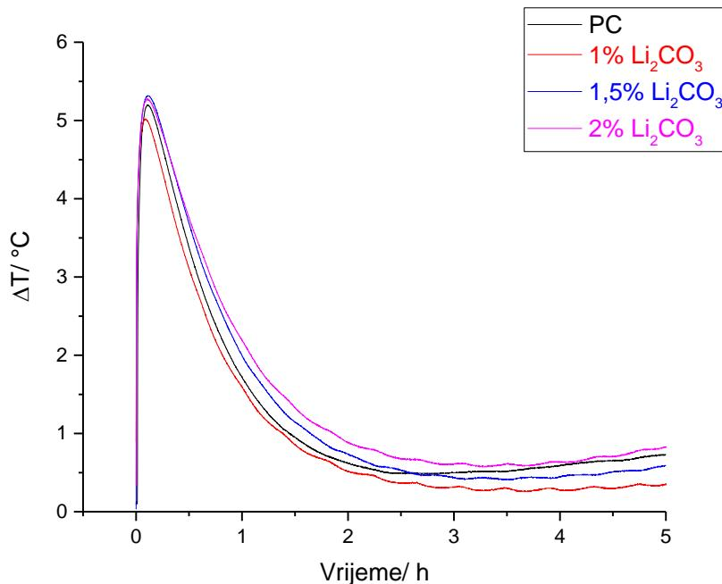
Slika 22: Promjena temperature uzorka u ovisnosti o vremenu hidratacije prvih 5 sati
