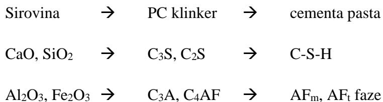
Shema ujedno upućuje i na osnovni oksidni sastav sirovinske smjese za proizvodnju Portland cementnog klinekra. [6]
