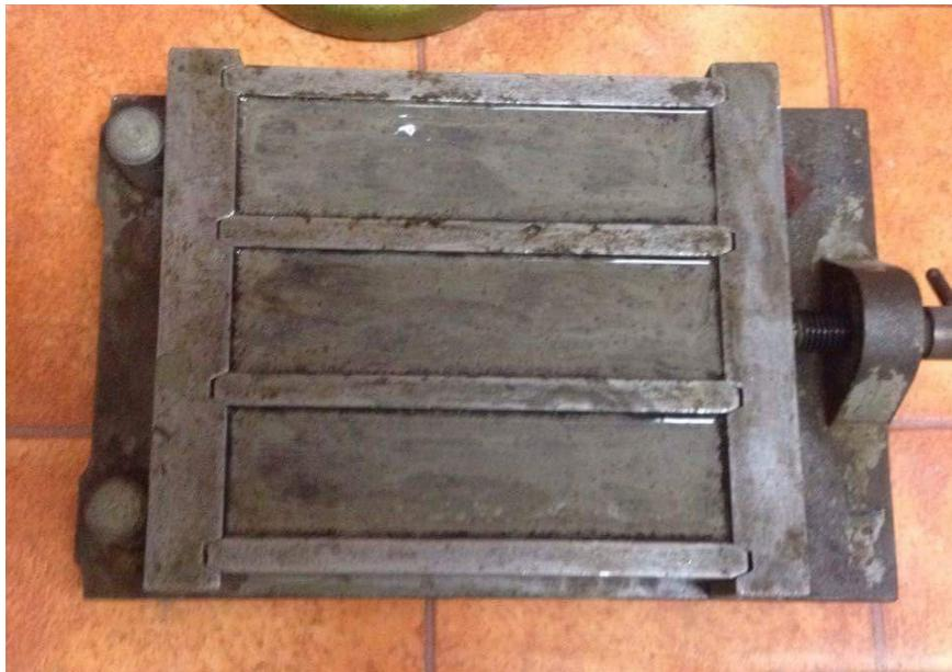
*Slika 13: Trodijelni kalup ispunjen cementnom pastom*
