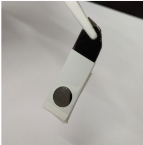
Slika 3.3. Elektroda pripremljena za sintezu
