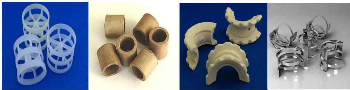
*Slika 2.18. Neke od vrsta nasipnih punila: a) Pall prsteni, b) Raschig prsteni, c) Intalox sedla, d) IMTP punila<sup>5,10</sup>*
