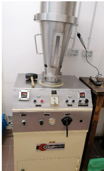
Slika 18. Fotografija granulatora s fluidiziranim slojem Uni-Glatt (Glatt GmbH, Binzen, SR Njemačka)
