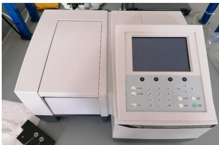
Slika 24. Fotografija UV/Vis spektrofotometra UV-1280 (Shimadzu, Kyoto, Japan)
