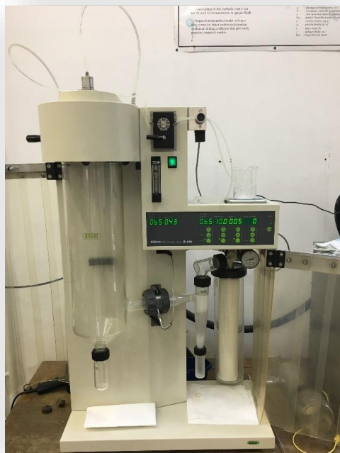
Slika 12. Fotografija sušionika s raspršivanjem Mini Spray Dryer B-290 (BÜCHI Labortechnik AG, Flawil, Švicarska)
