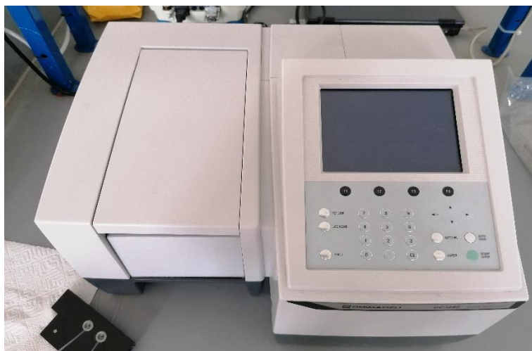
Slika 24. Fotografija UV/Vis spektrofotometra UV-1280 (Shimadzu, Kyoto, Japan)
