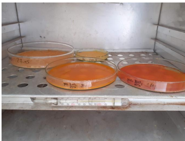
Slika 8. Sušenje BiVO 4 fotokatalizatora sintetiziranih metodom precipitacije.
