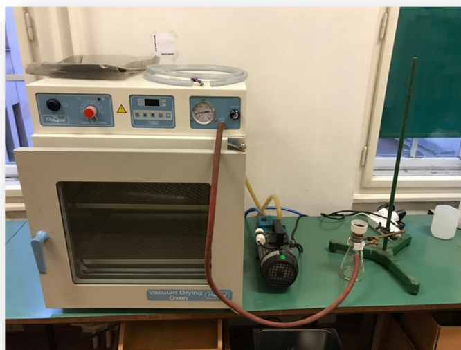
Slika 3.7. Aparatura za vakuum filtraciju
