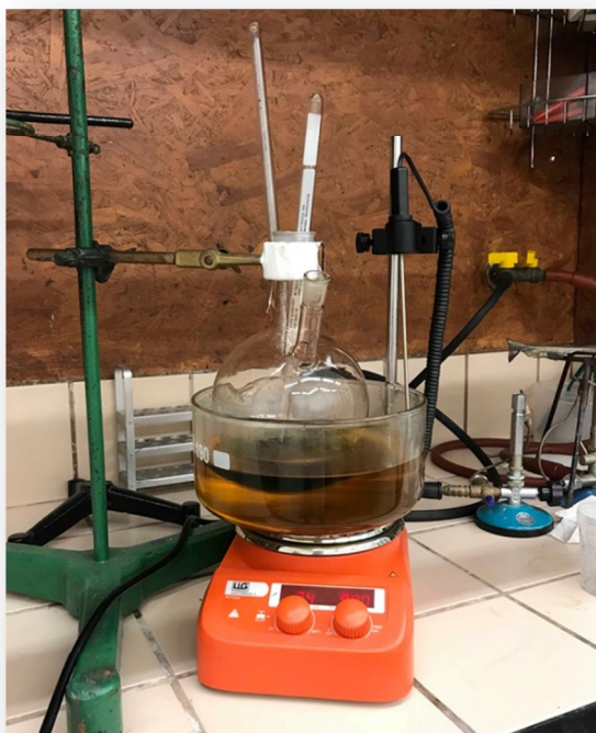
Slika 3.2. Aparatura za sintezu grafena Hummersovom metodom
