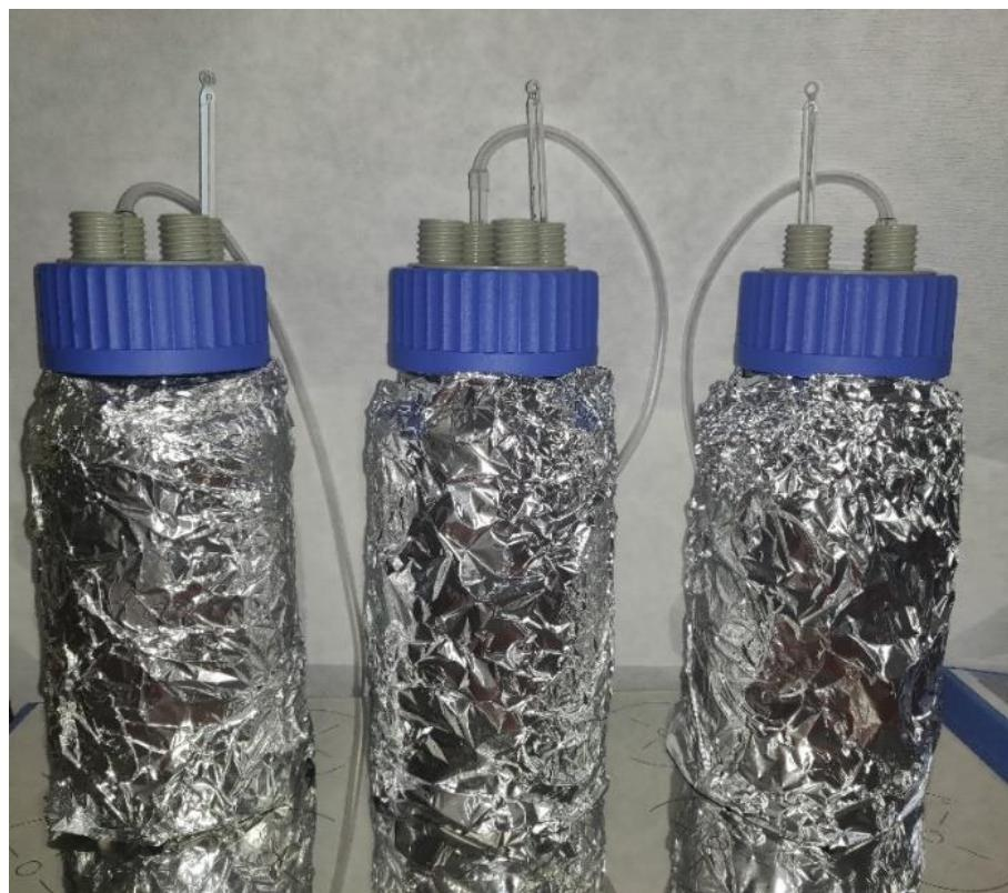
**Slika 3.2.** Prikaz reaktora za proces biorazgradnje
