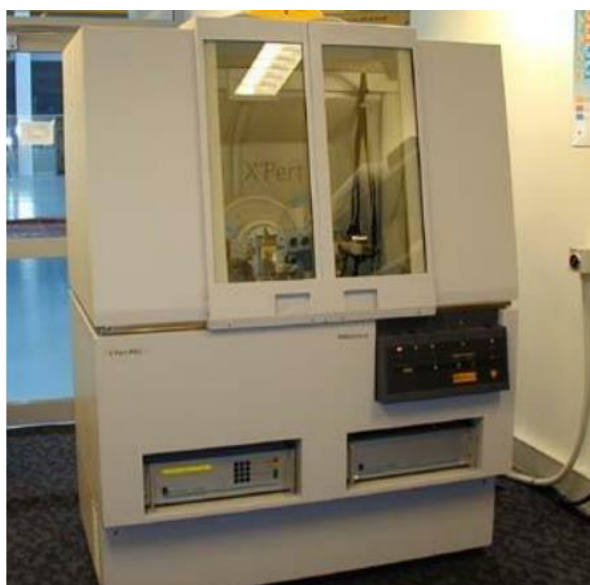
Slika 3.3. PANalytical X'Pert Pro difraktometar
