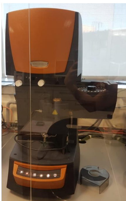
Slika 3.9. TA Instruments TGA uređaj
