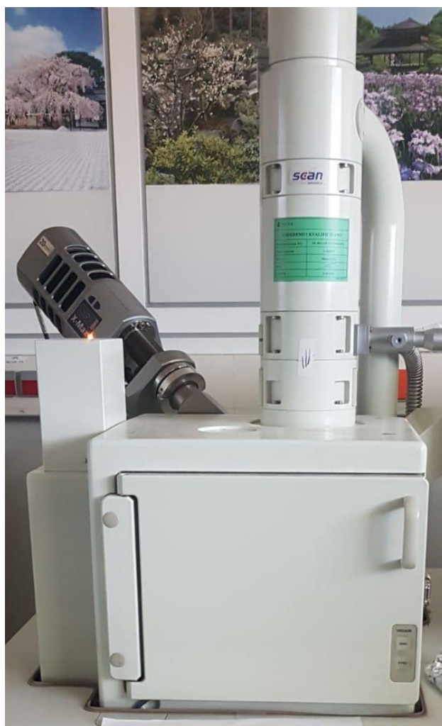
Slika 3.7. JSM 5800 pretražni elektronski mikroskop
