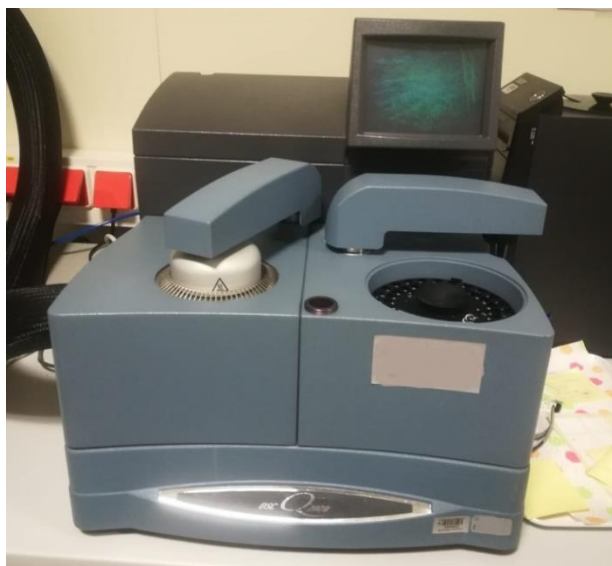
Slika 3.8. Mettler Toledo Q2000 diferencijalni pretražni kalorimetar
