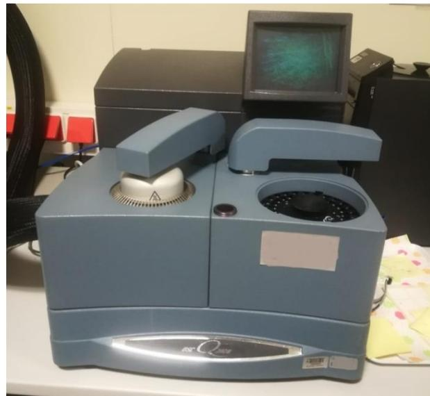
*Slika 3.8. Mettler Toledo Q2000 diferencijalni pretražni kalorimetar*
