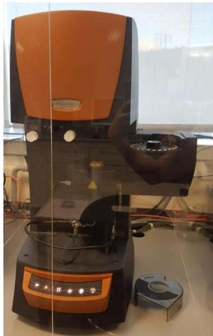
*Slika 3.9. TA Instruments TGA uređaj*
