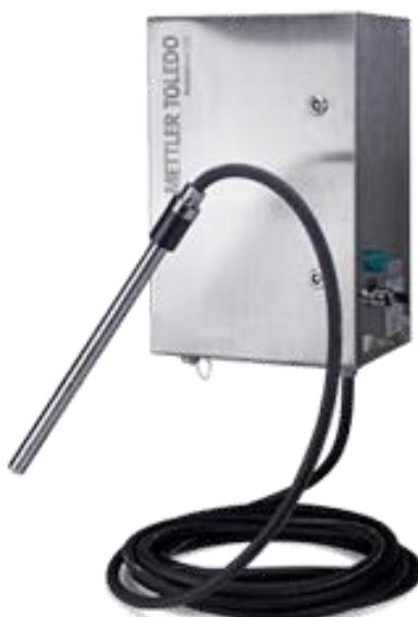
**Slika 3.4. Mettler Toledo FBRM sonda**
