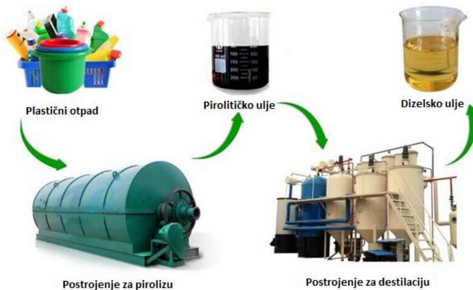
*Slika 9.* Proces proizvodnje dizelskog ulja iz otpadne plastike<sup>45</sup>
