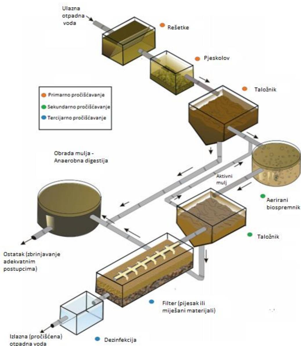
Slika 2.3. Shematski prikaz uređaja za pročišćavanje otpadnih voda.
