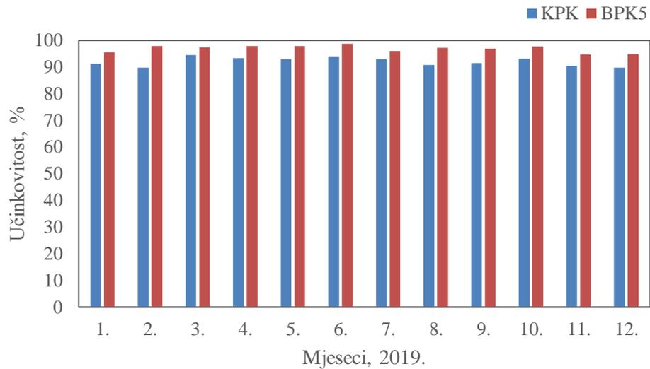
Slika 4.3. Grafički prikaz promjene vrijednosti uklanjanja KPK i BPK<sub>5</sub> u komunalnoj otpadnoj vodi CUPOVZ tijekom 2019. godine.
