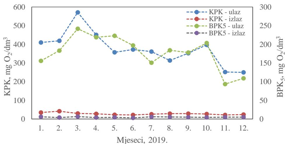
Slika 4.2. Grafički prikaz promjene vrijednosti KPK i BPK<sub>5</sub> u ulaznoj i izlaznoj komunalnoj otpadnoj vodi na CUPOVZ tijekom 2019. godine.
