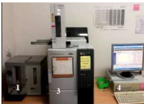
Slika 20. Sustav plinske kromatografije: 1 – generator vodika, 2 – sustav za automatsko injektiranje, 3 – plinski kromatograf, 4 – računalo
