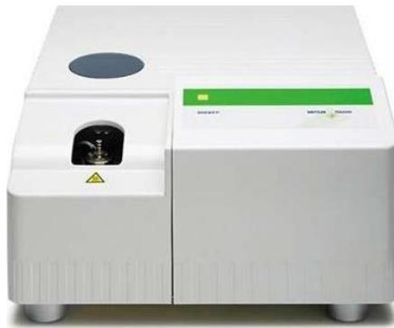
**Slika 14.** Fotografija diferencijalnog pretražnog kalorimetra Mettler Toledo 822<sup>e</sup>
