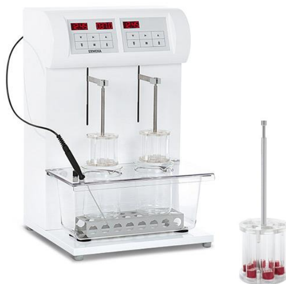
Slika 20. Fotografija uređaja za ispitivanje raspadljivosti tableta ZT 322 (Erweka GmbH, Langen, SR Njemačka)
