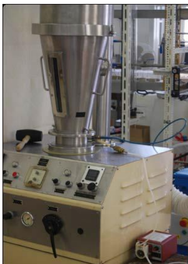
Slika 12. Fotografija granulatora s fluidiziranim slojem Uni-Glatt (Glatt GmbH, Binzen, SR Njemačka)
