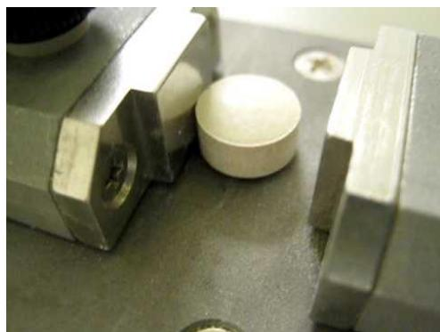
**Slika 19.** Fotografija uređaja za mjerjenje tvrdoće tableta
