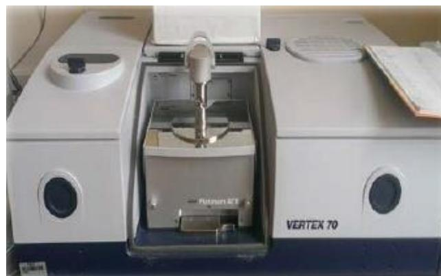
**Slika 15.** Fotografija FTIR spektrofotometra Vertex 70 s platinastim detektorom
