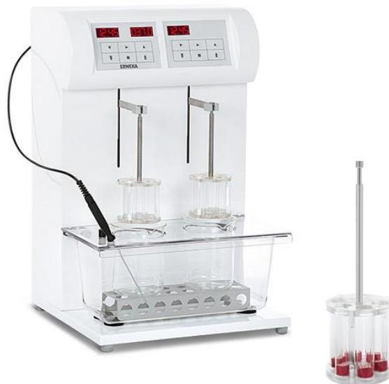
**Slika 20.** Fotografija uređaja za ispitivanje raspadljivosti tableta ZT 322
