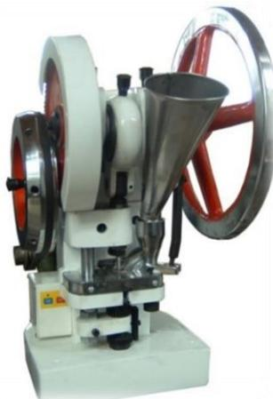
**Slika 13.** Fotografija uređaja za tabletiranje TDP-5T
