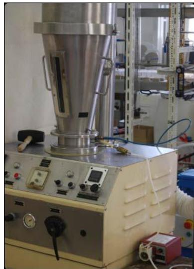
**Slika 12.** Fotografija granulatora s fluidiziranim slojem Uni-Glatt
