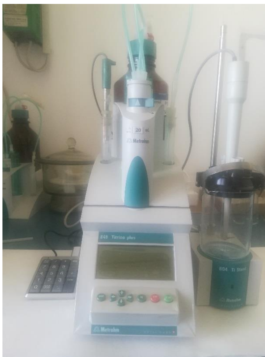
Slika 25. Instrument za određivanje ukupne kiselosti - Metrohm 848 Titrino Plus
