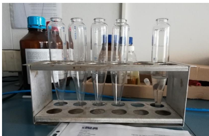
Slika 22. Kivete za centrifugu
