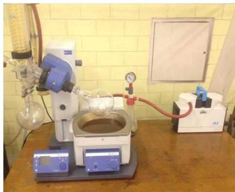
Slika 18. Rotacijski isparivač-IKA RV 10
