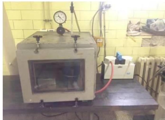
Slika 17. Vakuum sušionik
