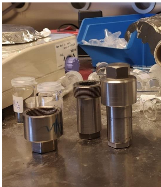
Slika 12. Reakcijska posuda od ojačanog kemijski inertnog čelika
