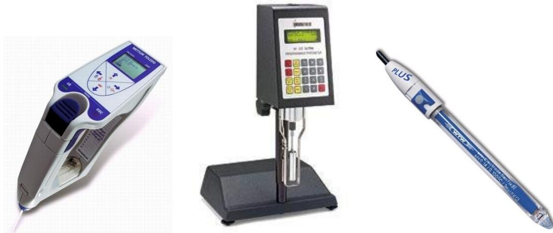
Slika 17. Densitometar, reometar, pH sonda.
