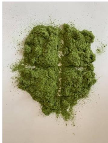
*Slika 14.* Četvrtanje uzorka.
