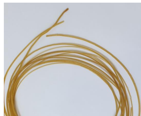
Slika 29. Fotografija filameta PVA TO 160C
