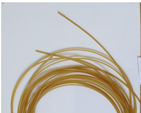
Slika 28. Fotografija filameta PVA TO 150C
