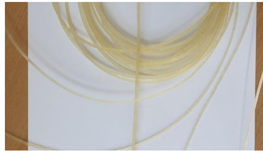
Slika 26. Fotografija filameta PVA FF 160C
