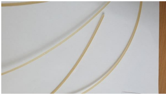
Slika 25. Fotografija filameta PVA FF 150C
