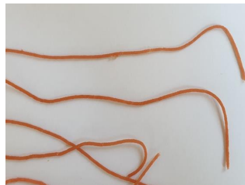
Slika 35. Fotografija filamenta PVA ATLAS 150C 20%
