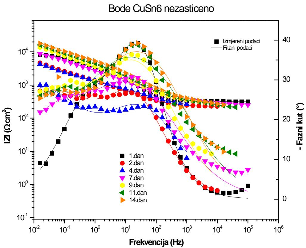
Slika 4.4. Bode-ov prikaz impedancijskih krivulja nezaštićenog CuSn<sub>6</sub> uzorka u vremenu
