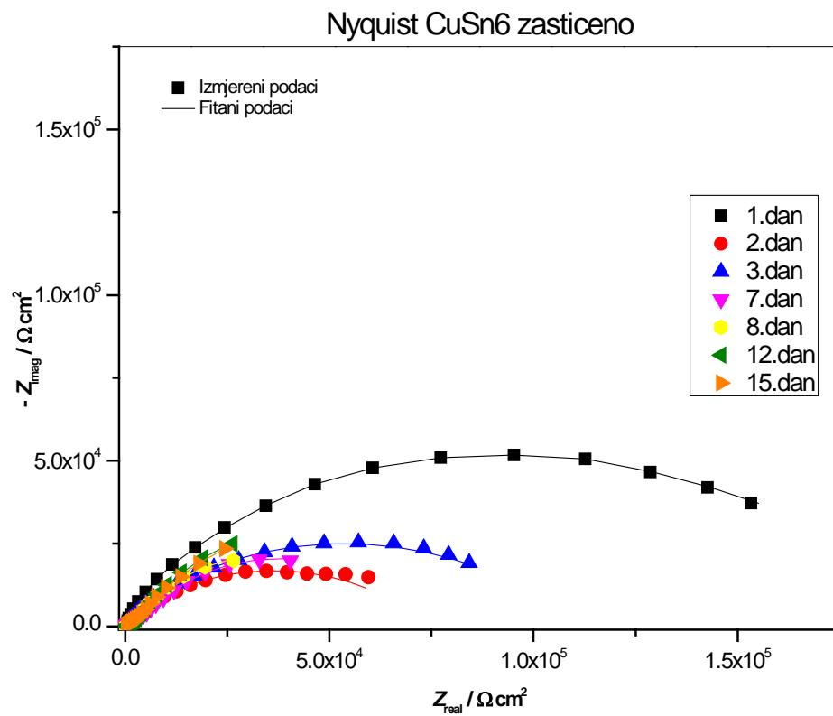
Slika 4.3. Nyquist-ov prikaz impedancijskih krivulja CuSn<sub>6</sub> zaštićenog uzorka u vremenu izlaganja umjetnoj kiši
