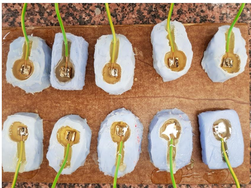
Slika 3.1. Zalijevanje radnih elektroda u epoksidnu smolu
