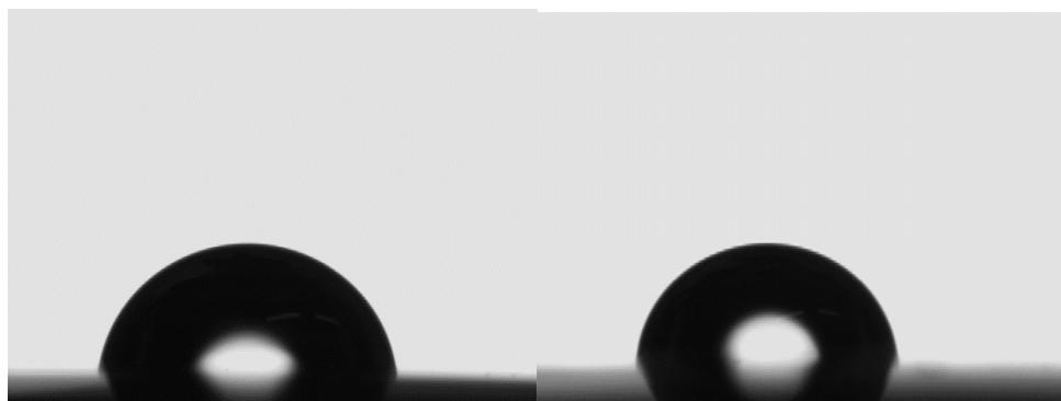
Slika 4.6. CuSn<sub>6</sub> nezaštićeno  $82,54 \pm 1,47^\circ$       CuSn<sub>6</sub> zaštićeno  $82,77 \pm 2,46^\circ$
