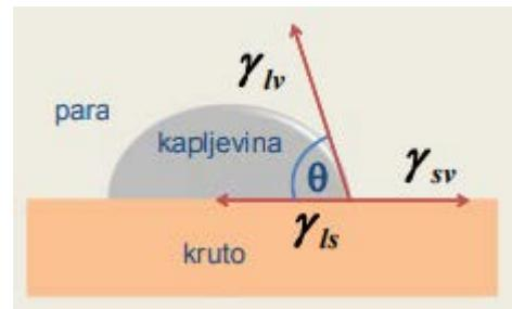
Slika 3.13. Određivanje kontaktnog kuta [32]
