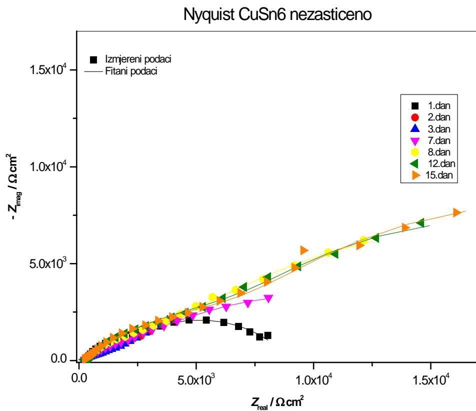
Slika 4.2. Nyquist-ov prikaz impedancijskih krivulja CuSn<sub>6</sub> nezaštićenog uzorka u vremenu izlaganja umjetnoj kiši
