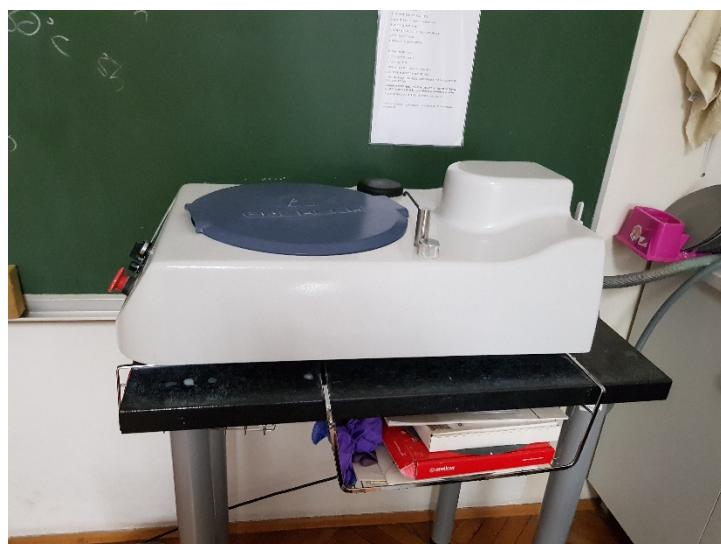
Slika 3.3. Uređaj za poliranje uzorka
