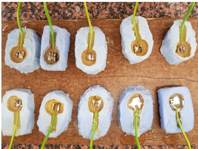
Slika 3.1. Zalijevanje radnih elektroda u epoksidnu smolu
