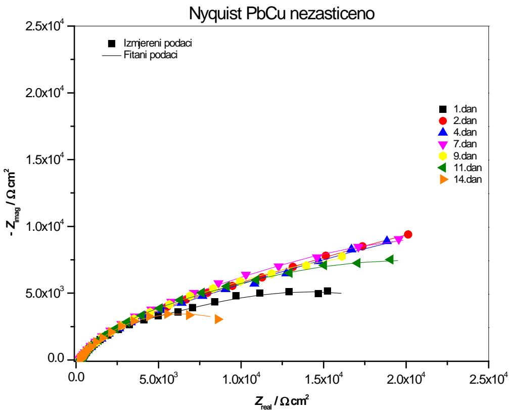
Slika 4.8. Nyquist-ov prikaz impedancijskih krivulja nezaštićenog PbCu uzorka u vremenu izlaganja umjetnoj kiši
