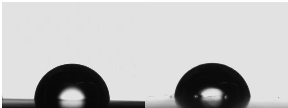
Slika 4.12. PbCu nezaštićeno  $85,60 \pm 2,20^\circ$  PbCu zaštićeno  $81,73 \pm 2,94^\circ$
