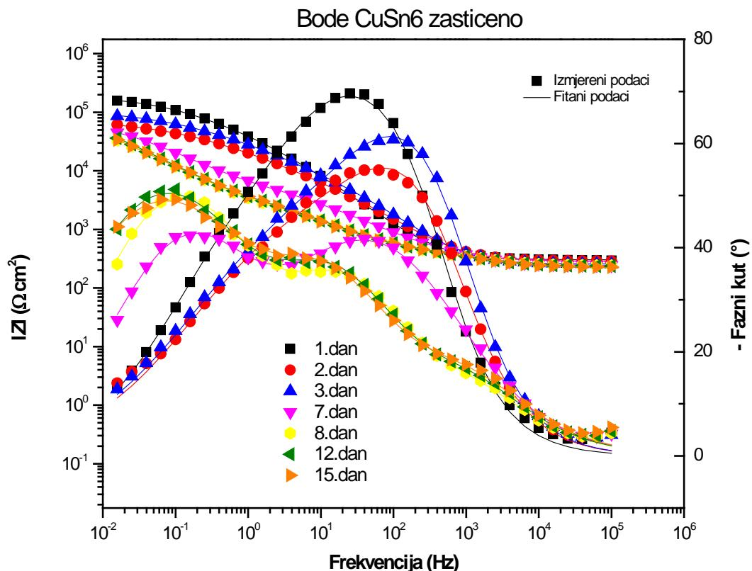
Slika 4.5. Bode-ov prikaz impedancijskih krivulja zaštićenog CuSn<sub>6</sub> uzorka u vremenu
