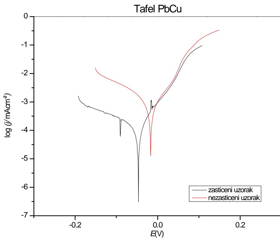
Slika 4.7. Prikaz ovisnosti potencijala o logaritamskoj vrijednosti struje za CuSn<sub>6</sub> uzorak
