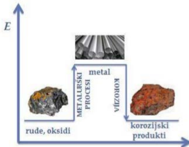
Slika 2.1. Energetske promjene pri dobivanju i koroziji metala [3]
