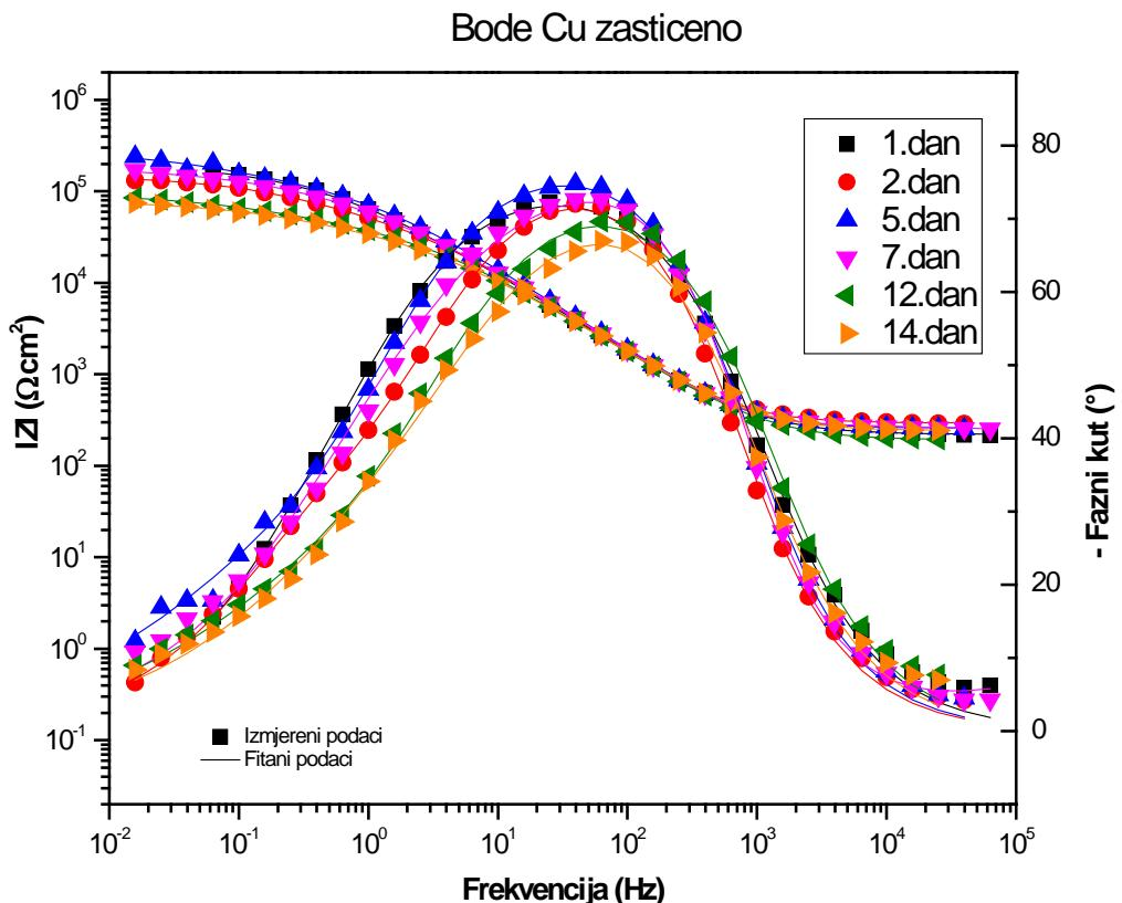
Slika 4.17. Bode-ov prikaz impedancijskih krivulja Cu uzorka zaštićeno u vremenu
