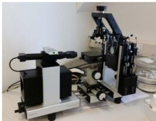
Slika 3.8. Goniometar, instrument za mjerjenje kontaktnog kuta, DataPhysics OCA 20 Instrument
