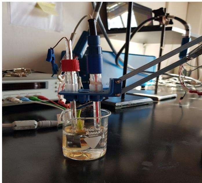
Slika 3.6. Troelektrodni sustav
