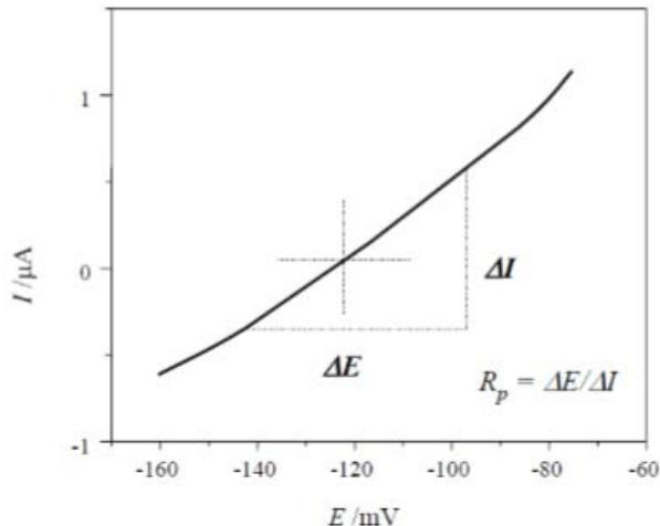
Slika 3.10. Određivanje polarizacijskog otpora prema Mansfeldu [1]
