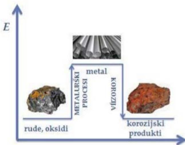
Slika 2.1. Energetske promjene pri dobivanju i koroziji metala [3]
