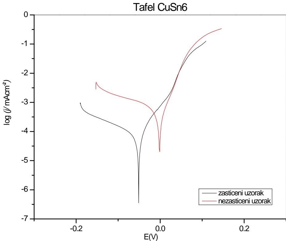
Slika 4.1.Polarizacijske krivulje za CuSn<sub>6</sub> uzorak
