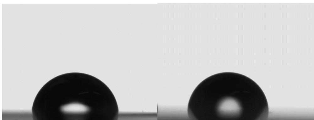
Slika. 4.18. Cu nezaštićeno  $84,28 \pm 1,48^\circ$
