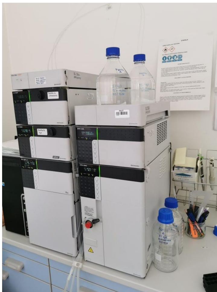
Slika 10. Uređaj za tekućinsku kromatografiju visoke djelotvornosti (HPLC)
