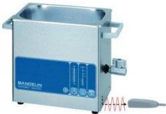
Slika 2. Ultrazvučna kupelj SONOREX DIGITAL DT 514 BH<sup>89</sup>
