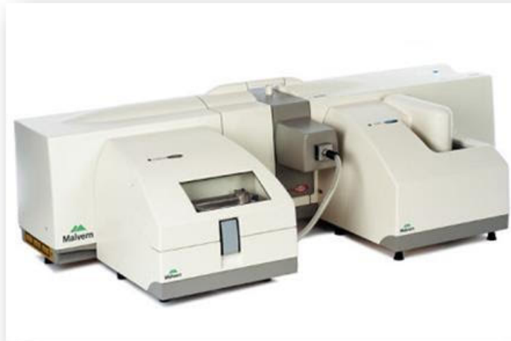
Slika 18. Uređaj za određivanje raspodjele veličina čestica Malvern .
