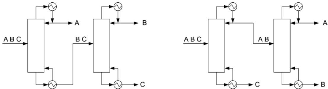
**Slika 2.** Konvencionalni nizovi za separaciju trokomponentnih smjesa [3]
