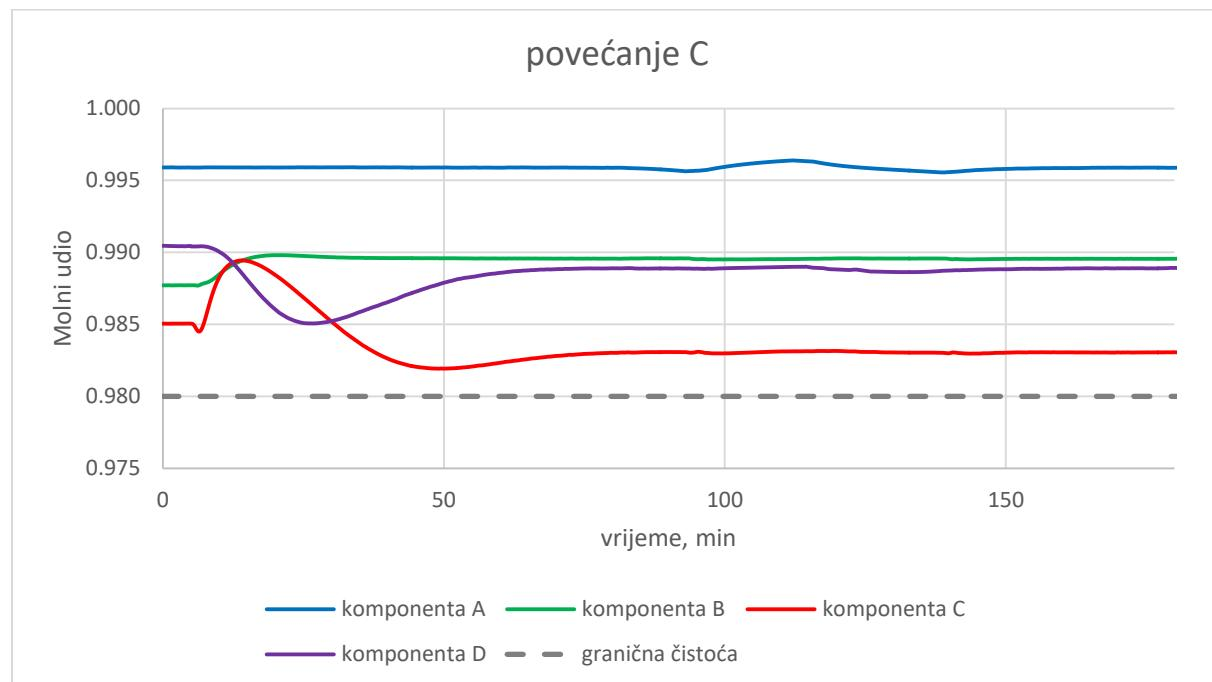
**Slika 15.** Dinamički odziv promjene količine komponente C (izobutanola)
