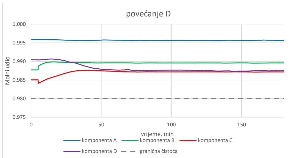
**Slika 16.** Dinamički odziv promjene količine komponente D (1-butanola)
