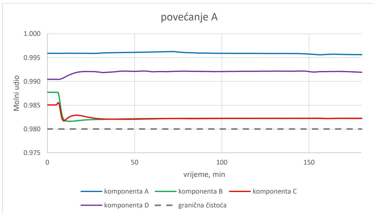
**Slika 13.** Dinamički odziv promjene količine komponente A (etanola)
