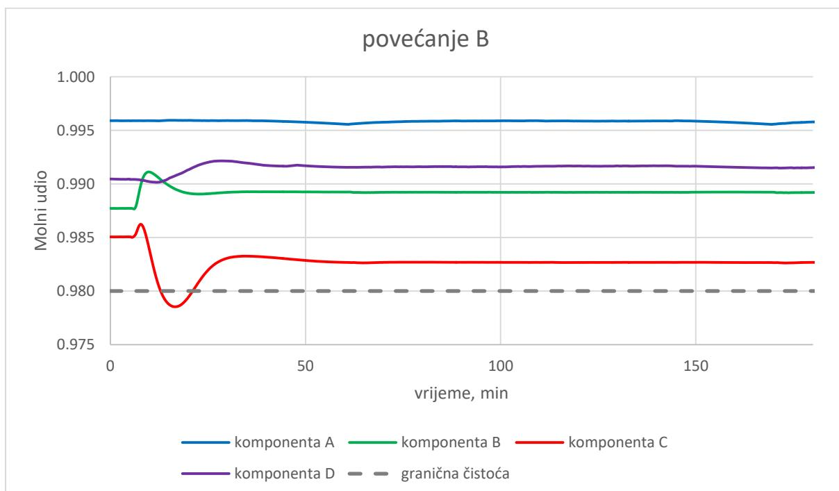
**Slika 14.** Dinamički odziv promjene količine komponente B (propanola)
