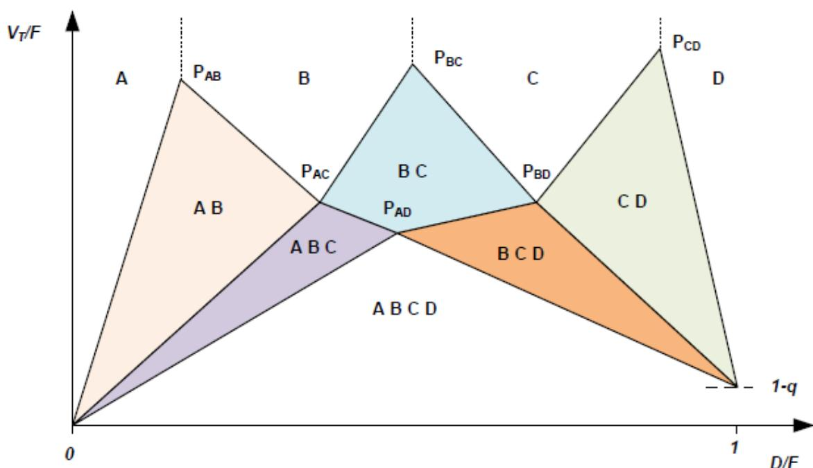
Slika 9. Vmin dijagram za četverokomponentni sustav [15]
