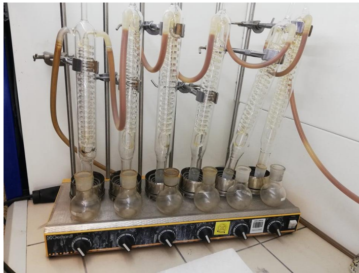
Slika 25. Aparatura za određivanje sadržaja gela
