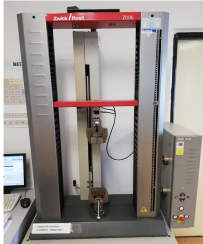
Slika 20. Mehanička kidalica ZwickZ005
