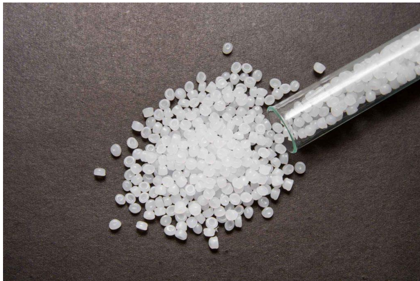
Slika 6. Prikaz granula polietilena [16]
