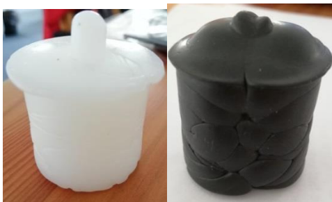
Slika 23. Primjer uzoraka za određivanje sadržaja gela pripremljenih tijekom rada na ekstruderu za a) izolaciju i b) plašt
