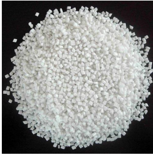
Slika 7. Prikaz granula polipropilena [18]
