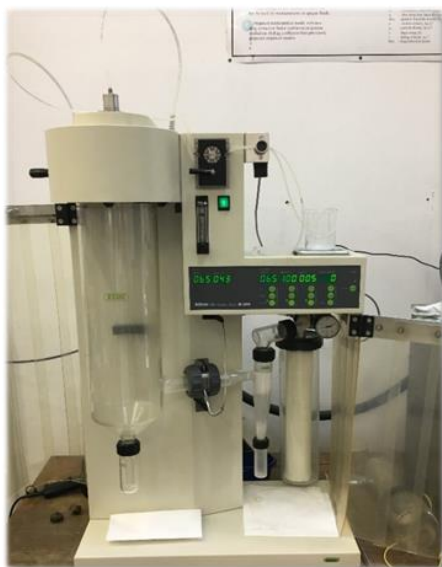
Slika 16. Fotografija laboratorijskog sušionika s raspršivanjem (BÜCHI Mini Spray-Dryer B-290).
