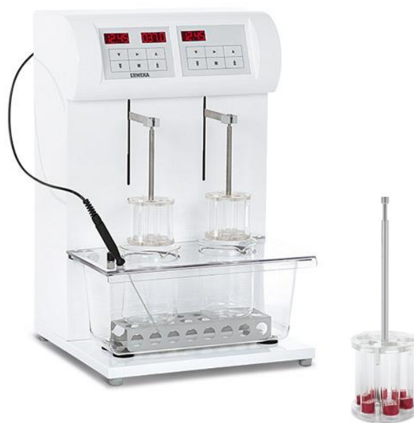
Slika 25. Fotografija uređaja za ispitivanje raspadljivosti tableta ZT 322 (Erweka GmbH, Langen, SR Njemačka).
