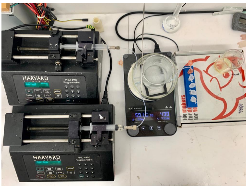
Slika 39. Provođenje sinteze biodizela u mikroreaktoru
