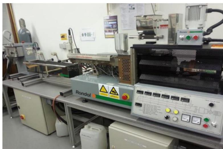
**Slika 11. Rondol 21mm LAB TWIN ekstruder**
